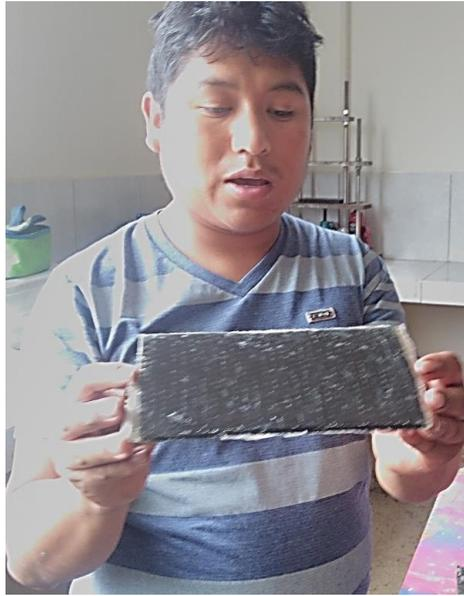
Observación de poros de las plaquetas del material compuesto de fibra de carbono y fibra de vidrio
