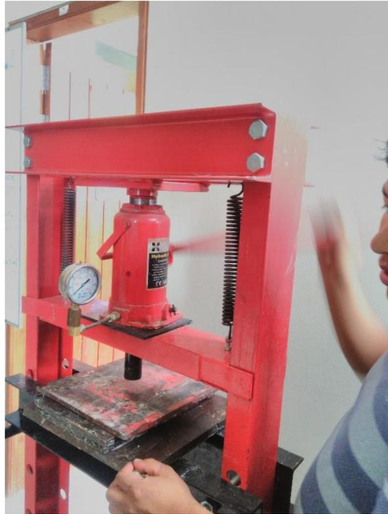
Prensa hidráulica aplicando una presión de 2000 PSI
