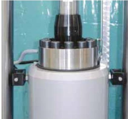
Para ensayos de tracción, que puede ser utilizado para diámetros de 8 a 30 mm y para barras planas con 3 a 40 mm (grosor), 60 mm (ancho). La tasa de carga en el campo elástico debe ser seleccionada de 5 a 30 N/mm<sup>2</sup>/s.
