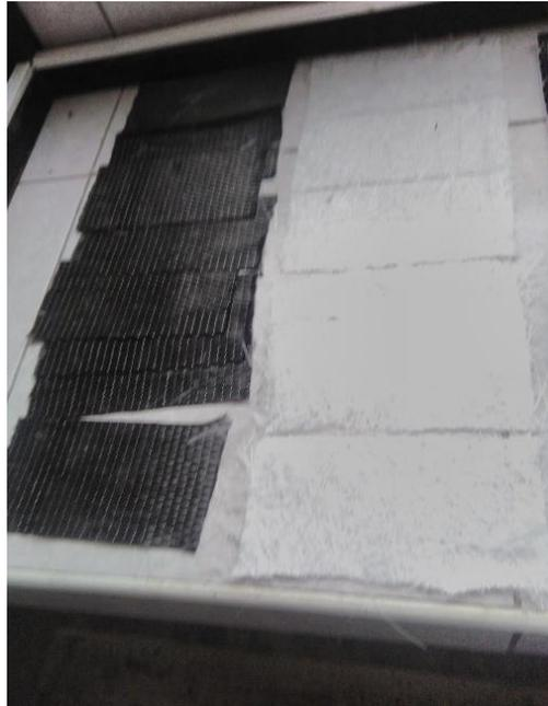
Corte de la fibra de carbón y fibra de vidrio en pequeñas capas para el molde
