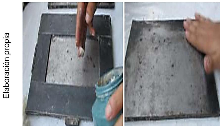
Encerado de la parte interna del molde (a) y de la tapa (b)
