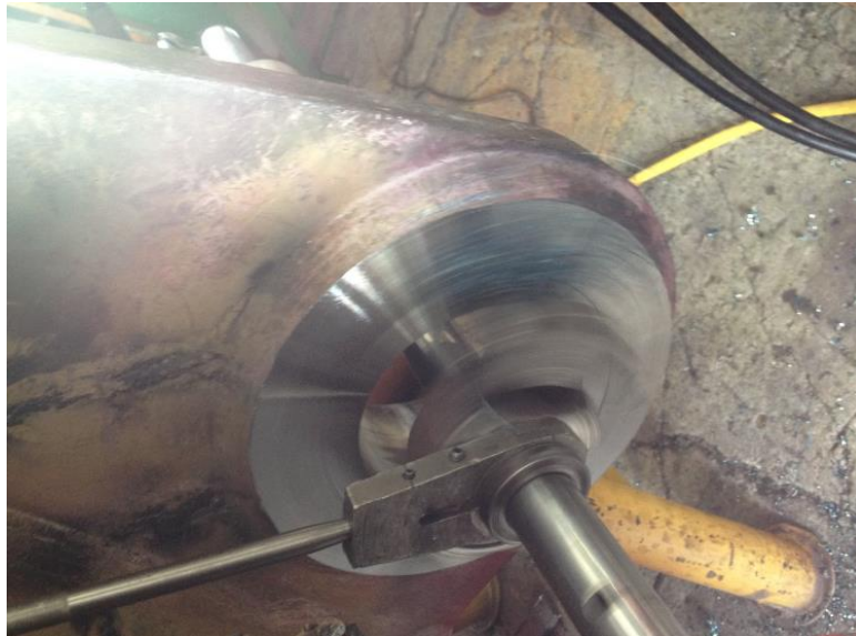
IMAGEN 7: Cara maquinada con el refrentador
