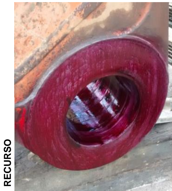
IMAGEN 8: Alojamiento y cara inspeccionada por NDT
