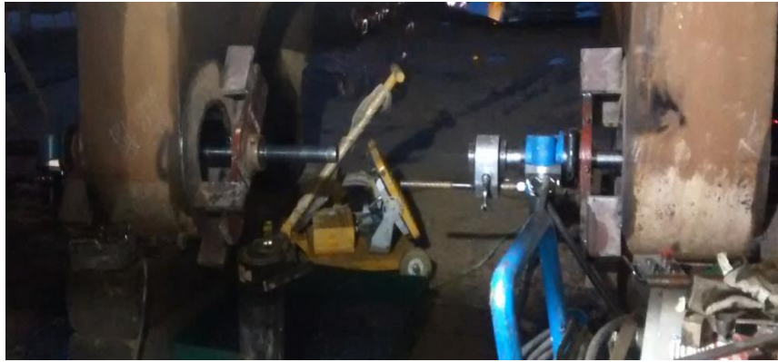
IMAGEN 11: Alineamiento y se suelda los soportes de chumacera
