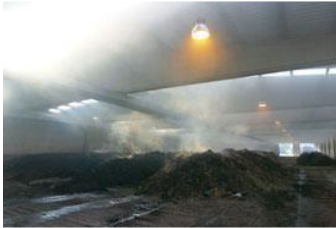
Figura 37. Apilamiento, Planta de tratamiento de “RSU” con producción de energías renovables- empresa COGERSA, Fuente: http://www.cogersa.es/metaspacesportal/14498/19176 edición: propia 2017
