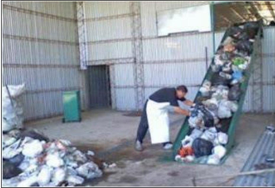
Figura 26. Tolva alimentadora-Planta de tratamiento de “RSU” residuos sólidos urbanos con producción de energías renovables-Empresa COGERSA
