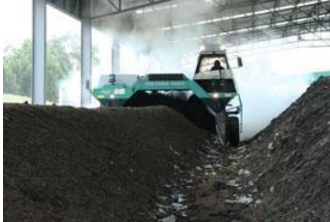
Figura 39. Apilamiento, Planta de tratamiento de “RSU” con producción de energías renovables- empresa COGERSA, Fuente:
