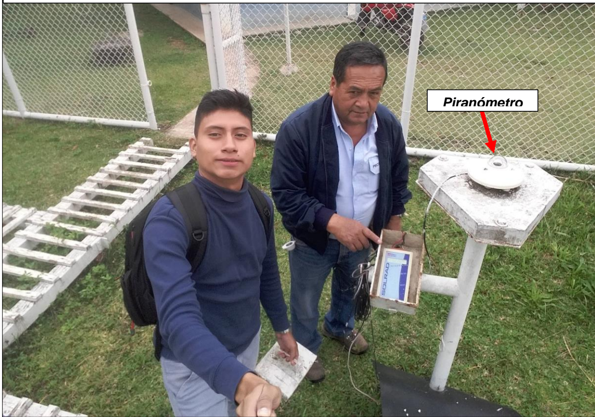
Piranómetro, instrumento meteorológico utilizado para medir la radiación solar.
