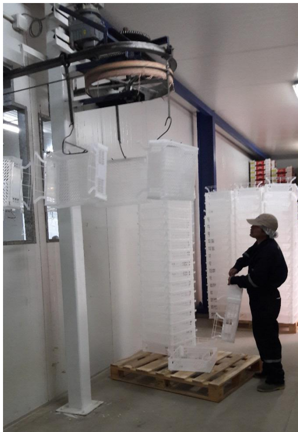
Figura 71. Abastecedor de cajas– Empresa Agroexportadora.
