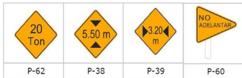
Figura 27: Señales preventivas por restricciones físicas de la vía.
