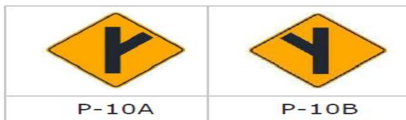
Figura 28: Señales preventivas de intersección con otra vía.
