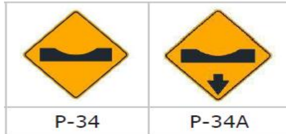
Figura 26: Señales preventivas según superficie de rodadura.
