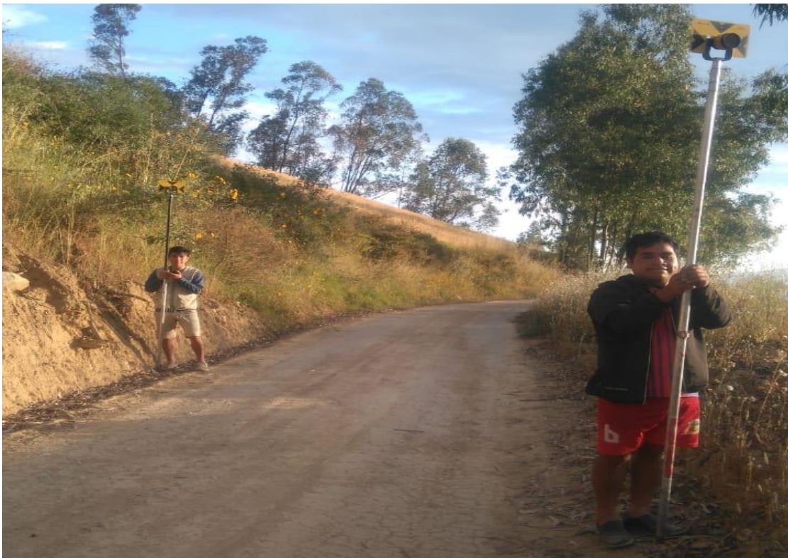
Figura 6: En la figura se muestra a los prismeros dando los puntos de borde de la trocha carrozable al topógrafo.
