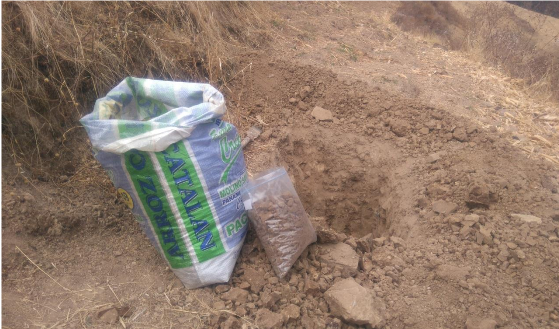
Figura 9: En la figura se aprecia las muestras extraídas de la calicata para CBR el saco grande y para los demás ensayos la bolsa pequeña.
