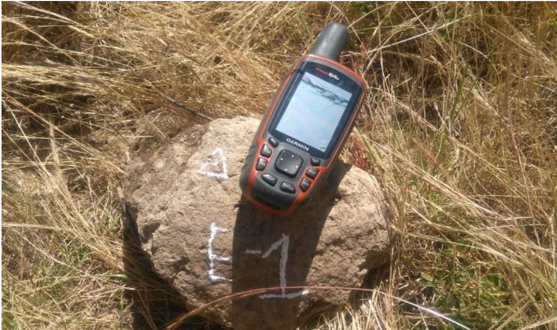
Figura 7: En la figura se muestra la toma de las coordenadas de la primera estación del levantamiento topográfico.
