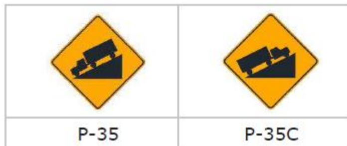
Figura 25: Señales preventivas por geometría vertical.
