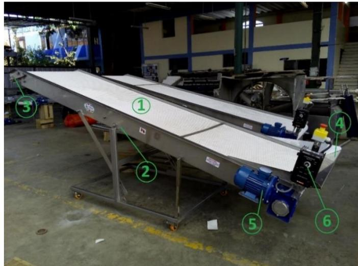
Figura 3. Transportador inclinado de PVC media luna
