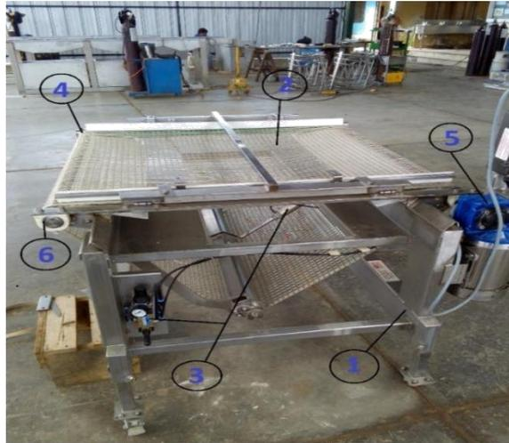
*Figura 6.* Calibradora de malla de poliuretano
