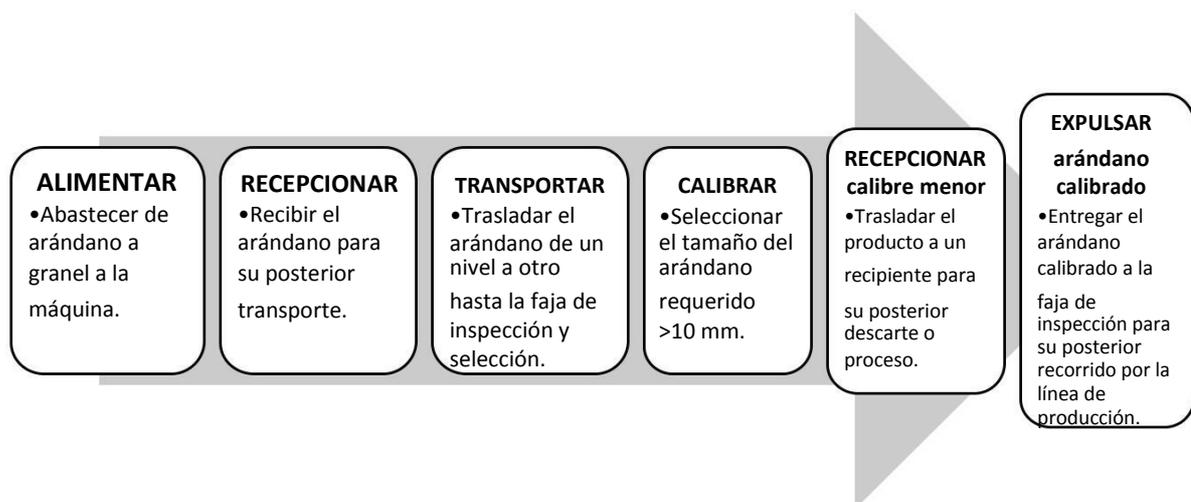
Figura 28. Estructura de funciones
