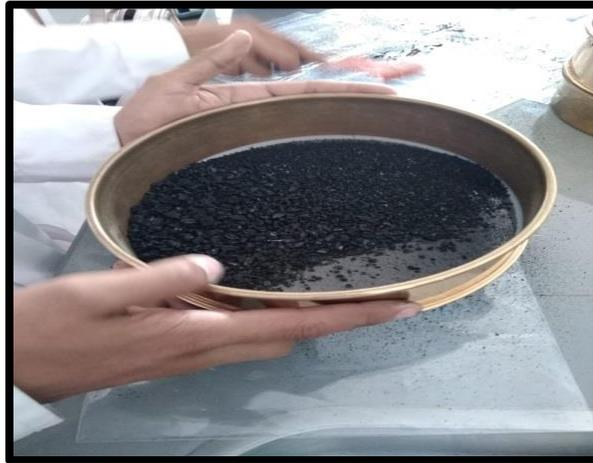
*Figura 13: Tamizado de carbón activado*
