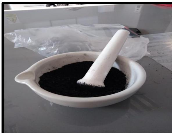
*Figura 12: Trituración del carbón activado*
