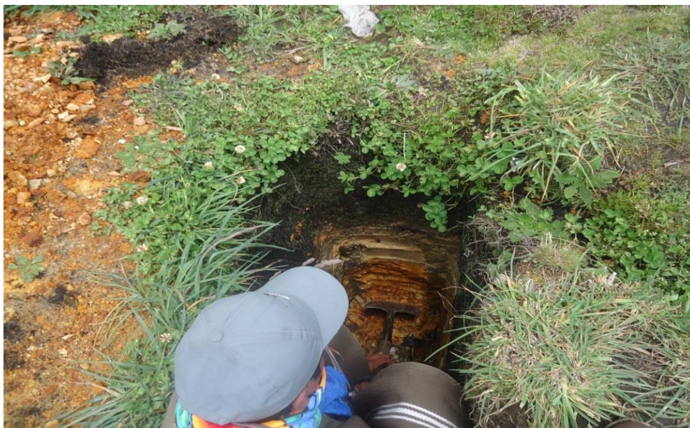
Vista fotográfica donde se aprecia la calicata de donde se sacaron las muestras en el terreno donde se construirá el Local Municipal de C.P de Cadmalca
