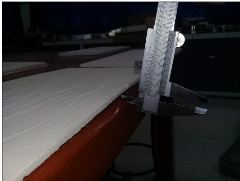
Ensayo con el vernier para hallar su deflexión por humedecimiento.
