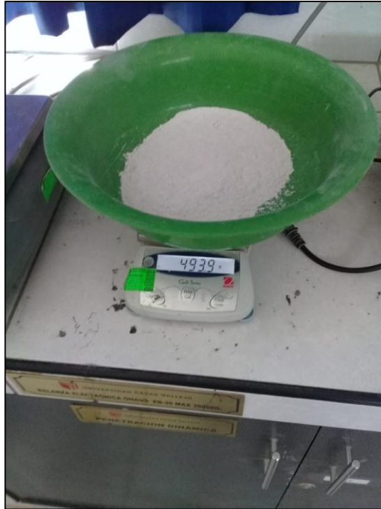
Pesado del yeso y cal según dosificación indicada.
