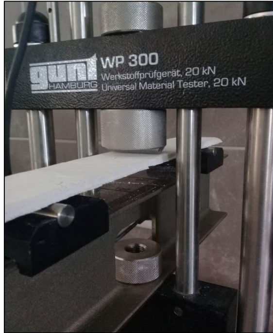
Equipo Universal "Gunt Hamburg WP 300", resistencia a la flexión.
