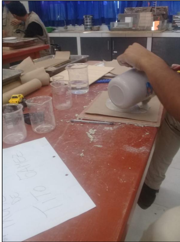
Vaceado de la mezcla de estuco en el molde.
