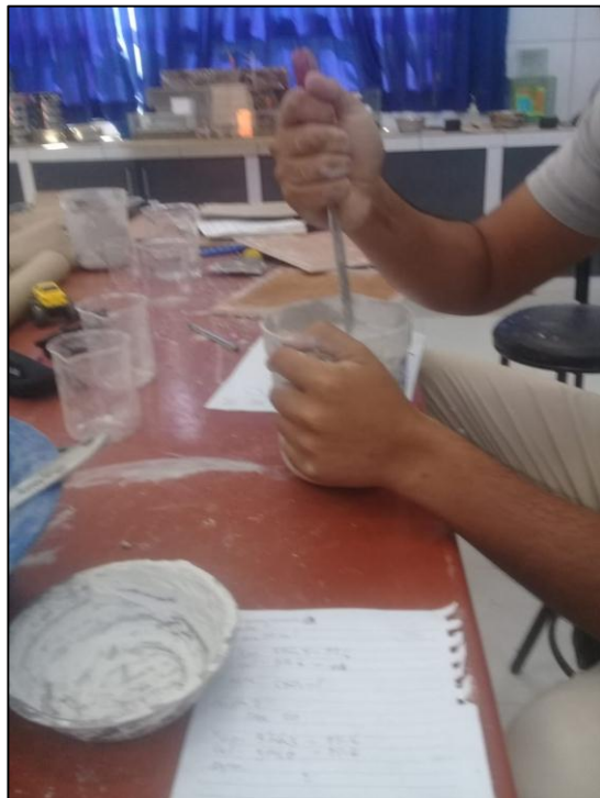
Mezclado del yeso y cal en un recipiente.
