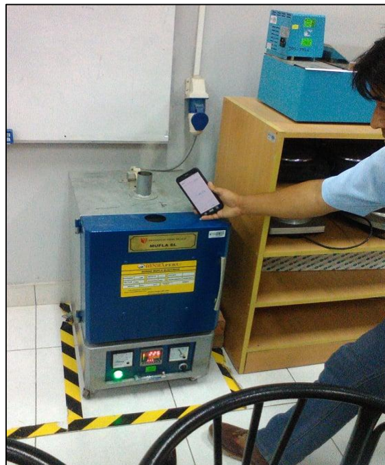
Ensayando en el equipo "MUFLA 6L", midiendo con el tiempo de calcinación hasta llegar a 1000 C°.
