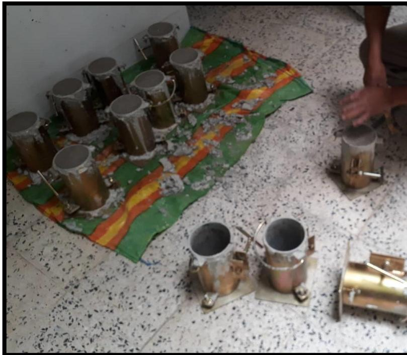
En esta fotografía se aprecia el desencofrado de las Probetas que contienen 30% de Vidrio triturado.
