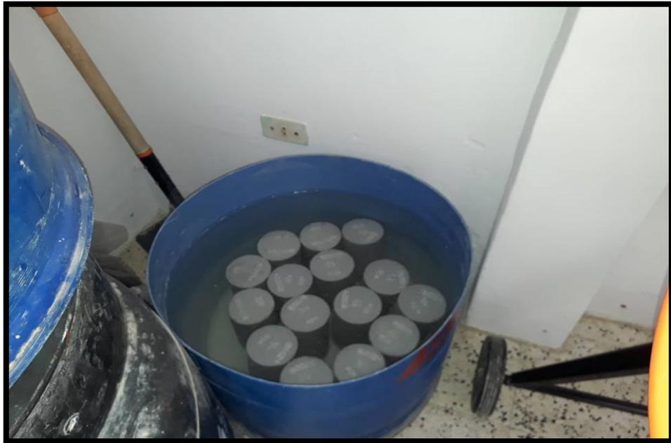
En esta fotografía, las probetas diseño 210kg/cm<sup>2</sup>, en agua, para luego pasar por el proceso de Rotura de Probetas a los 7, 14, 21 y 28 días.
