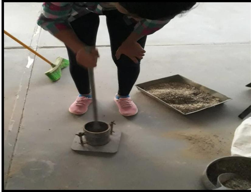
En esta fotografía se aprecia el ensayo de Peso Unitario Varillado de los Agregados.
