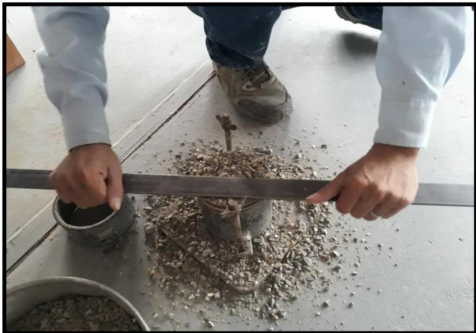
En esta fotografía se observa el ensayo de Peso unitario de los Agregados.
