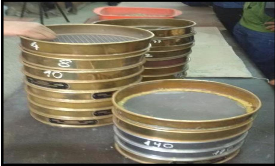
En esta fotografía se aprecia una serie de tamices a utilizarse, para realizar el ensayo de granulometría a cada uno de los agregados.
