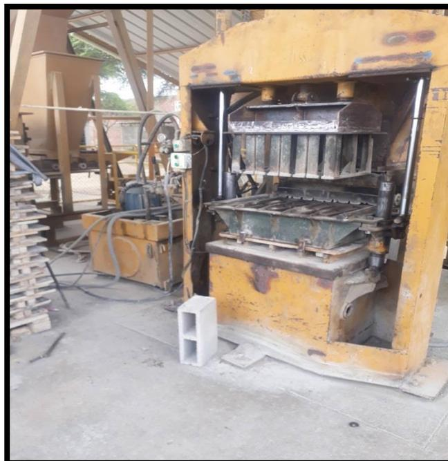
En esta fotografía se aprecia la Prensa que fabrica los bloques de concreto tradicional y bloques con vidrio triturado.
