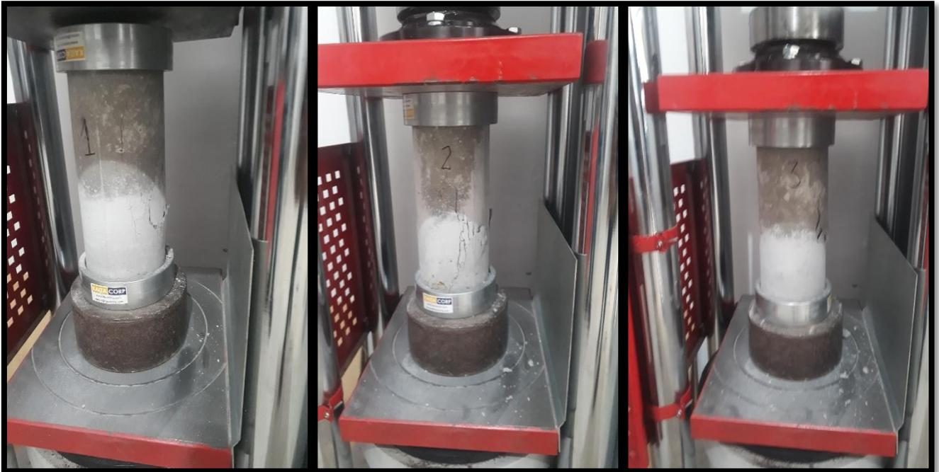
En estas fotografías se aprecias las probetas que pasaron por el proceso de Rotura, Diseño  $f'c=210\text{kg/cm}^2$ .
