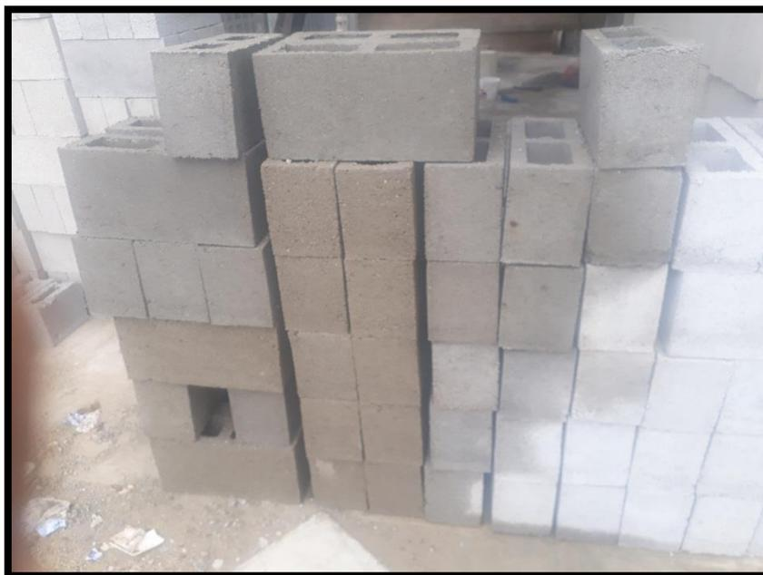
En esta imagen se puede observar los bloques de concreto elaborados con vidrio y sin vidrio.
