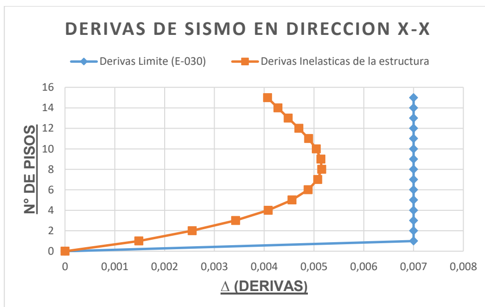
Figura 67. Distorsiones de entrepisos en dirección x-x, de la estructura de base fija.
