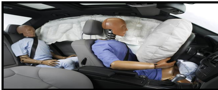
Figura 22. Función de la bolsa de aire ante un choque de los vehículos.
