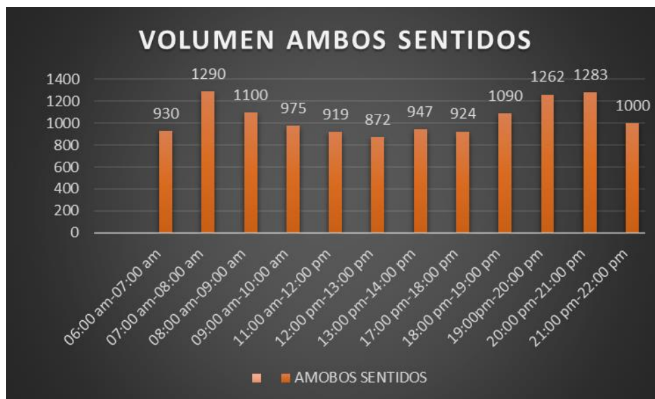
Figura 49. Registro del volumen vehicular en ambos sentidos del día jueves 09 de agosto, en las cuales se registró que el volumen horario de máxima demanda se dio en la hora de 7 am a 8 am de la mañana.
