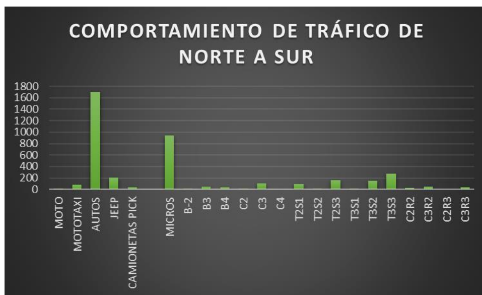
Figura 58. En la siguiente imagen se demuestra por medio de un gráfico de barras el comportamiento vehicular de norte a sur donde se registró con mayor cantidad las unidades de autos. Fuente: Propia del investigador.
