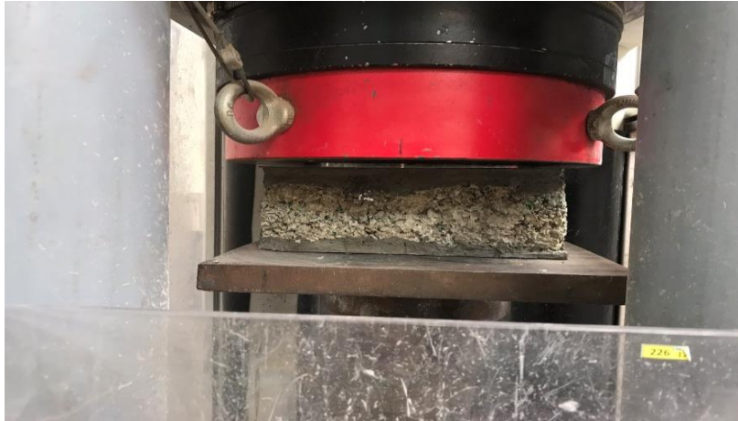
Figura 9. Ensayo de Resistencia a Compresión del ladrillo con agregado de plástico. Fuente: elaboración propia.
