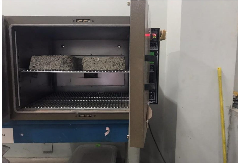
Figura 12. Muestras llevadas al horno para su evaluación. Fuente: elaboración propia.
