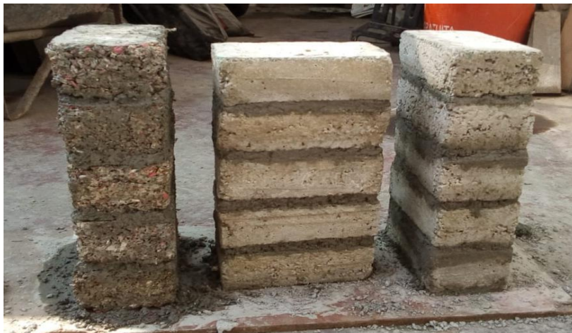
Figura 13. Muestras para el ensayo a compresión de pilas. Fuente: elaboración propia.
