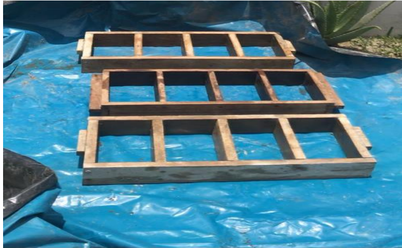
Figura 6. Moldes de madera para elaboración de ladrillos de plástico reciclado. Fuente: elaboración propia.
