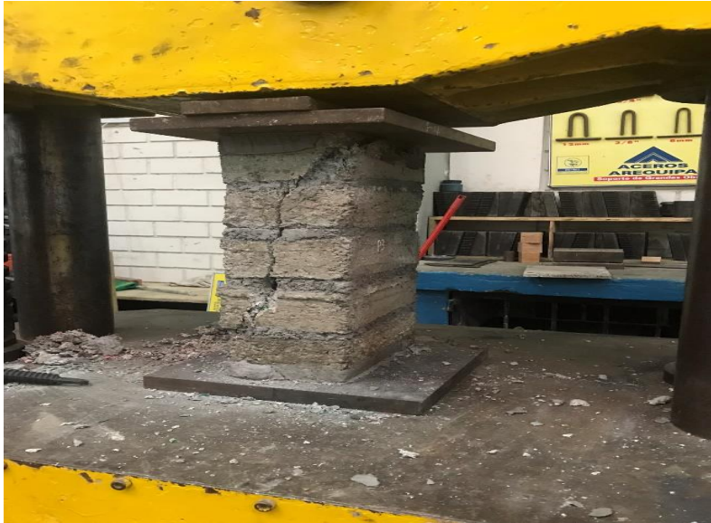
Figura 14. Ensayo de Resistencia a la compresión de pilas. Fuente: elaboración propia
