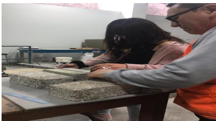
Figura 18. Medición de las muestras de los ladrillos con agregados de plástico. Fuente: Elaboración propia.
