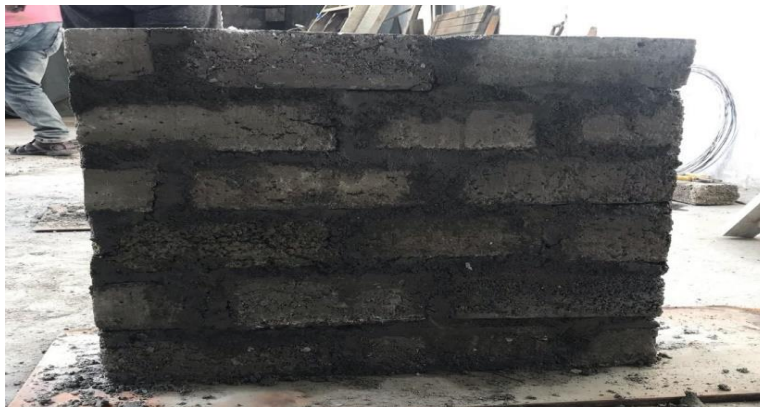
Figura 15. Muestra 1 para el ensayo a Compresión Diagonal en Murete. Fuente: elaboración propia.
