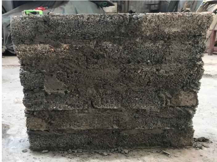
Figura 16. Muestra 2 para el ensayo a Compresión Diagonal en Murete. Fuente: elaboración propia.
