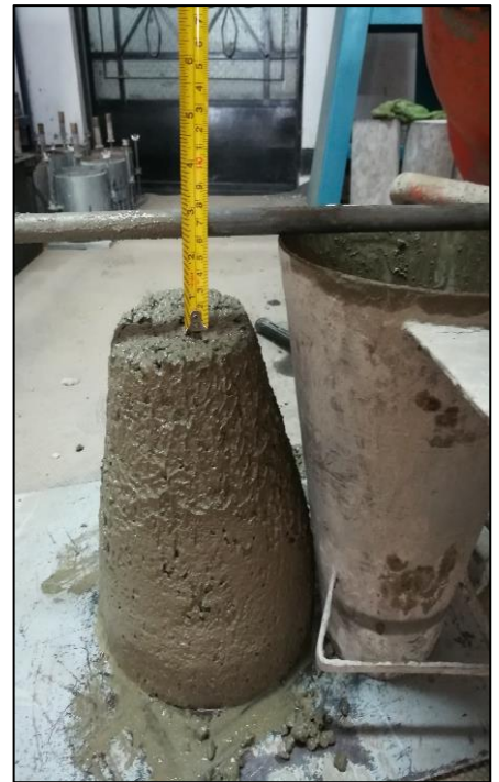
Foto N 17. Ensayo de asentamiento
