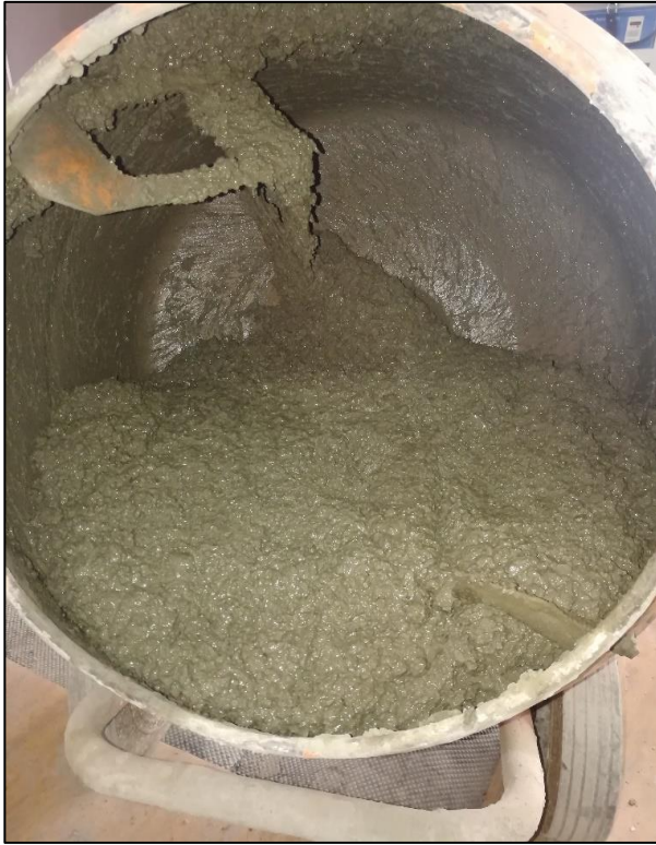
Foto N 18. Mezcla del concreto patrón
