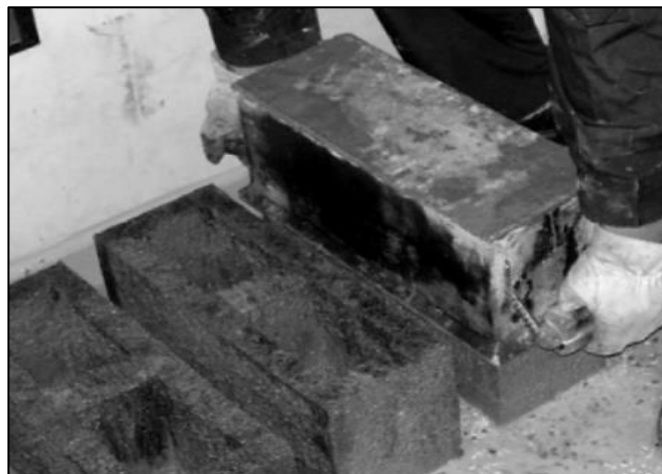
Figura 3. Bloque de hormigón recién desmoldado. Fuente: Valdés y Rapimán (2007).
