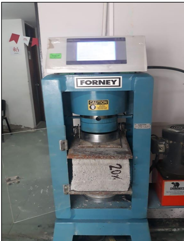
Foto N 39. Ensayo de Resistencia a la compresión del concreto con el 20 % de agregado reciclado
