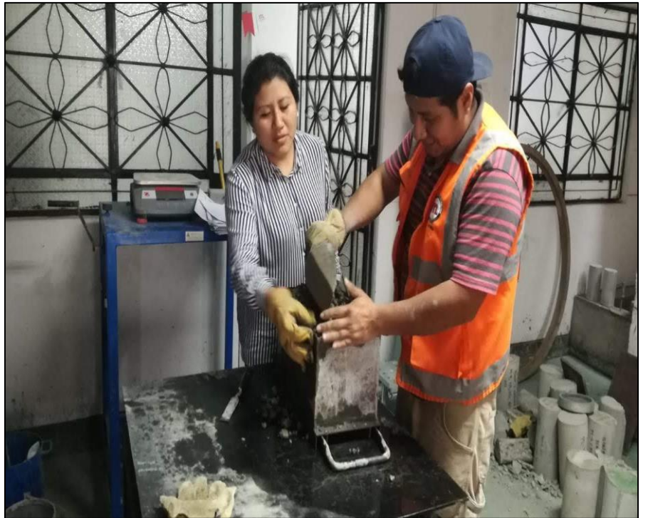
Foto N 21. Vaciado del concreto en molde metálico
