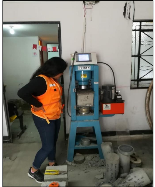
Foto N 38. Ensayo de Resistencia a la compresión
