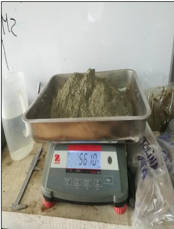
Foto N 11. Diseño de mezcla del concreto (cantidad del cemento)
