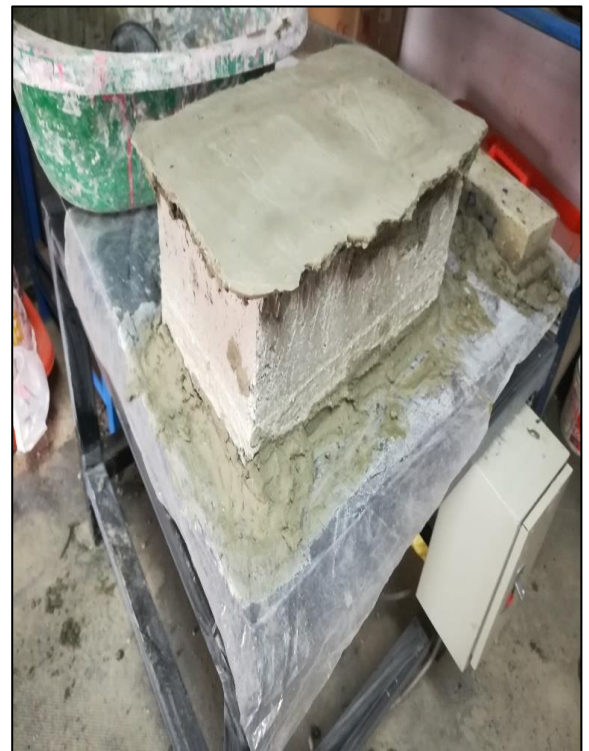
Foto N 36. Acondicionamiento de bloque de concreto con diablo fuerte
