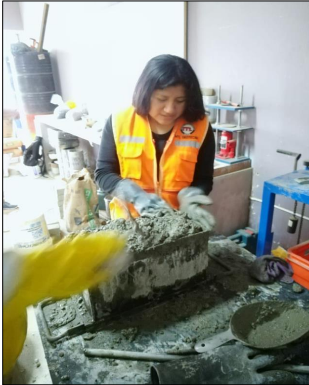
Foto N 22. Vaciado del concreto al molde metálico
