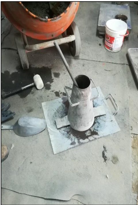
Foto N 15. Ensayo de asentamiento
