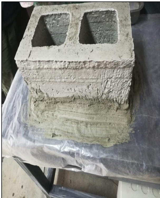
Foto N 35. Acondicionamiento de bloque de concreto con diablo fuerte
