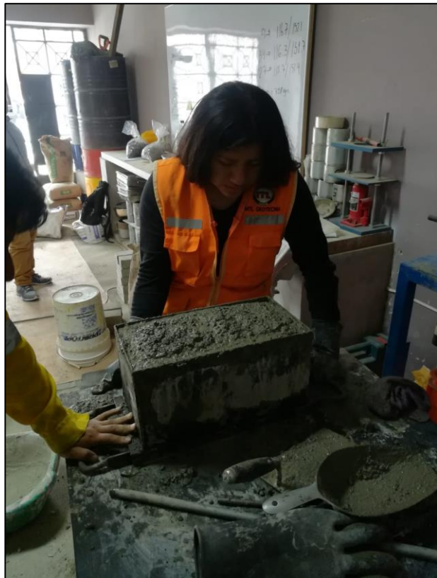
Foto N 25. Vibración del concreto
