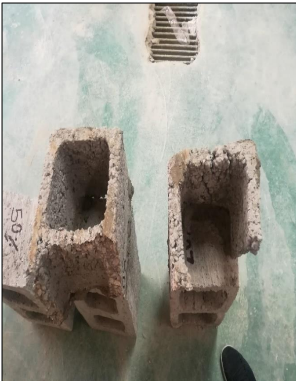
Foto N 43. Roturas del bloque de concreto al 80% de agregado reciclado
