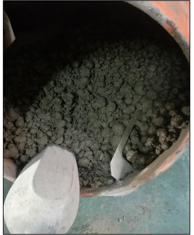
Foto N 19. Mezcla de concreto patrón con el 80% de agregado reciclado
