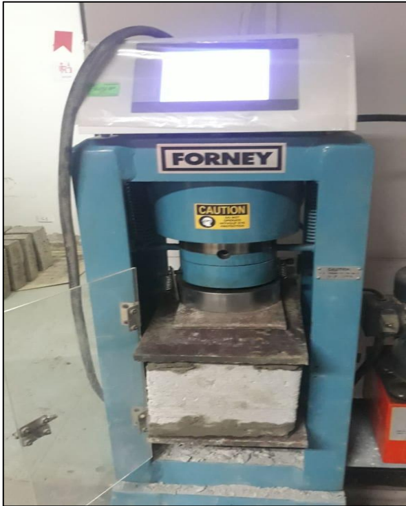
Foto N 37. Ensayo de Resistencia a la compresión
