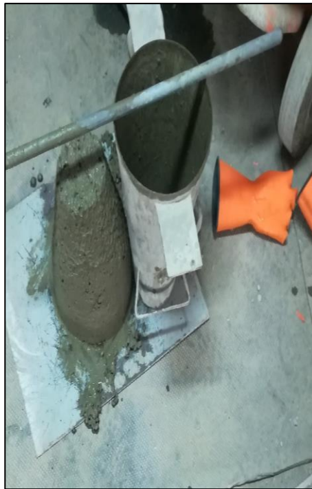
Foto N 16. Ensayo de asentamiento
