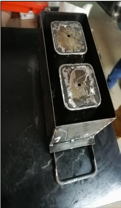
Foto N 20. Molde metálico
