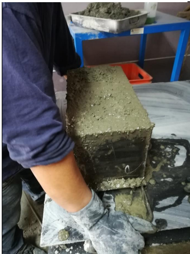
Foto N 24. Vibración del concreto
