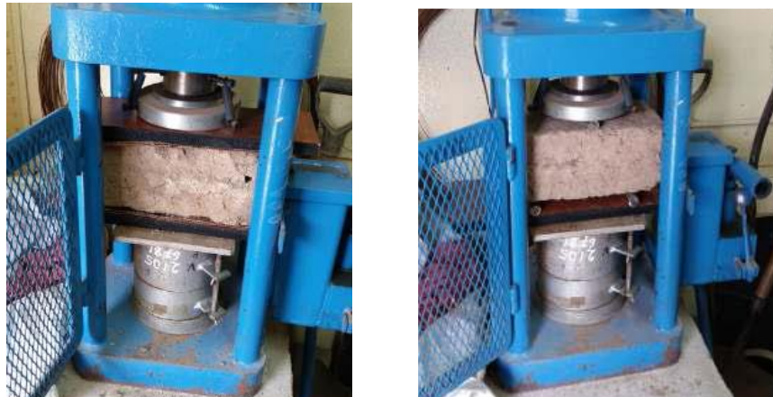
Figura 2-1: Ensayos de resistencia a la compresión y de flexión en unidades de adobe.
