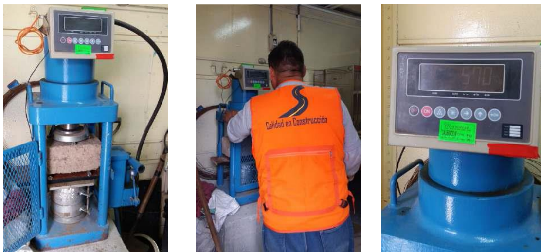
Figura 3-7: Colocación y aplicación de carga flexional en especímenes de adobe. Fuente: Elaboración propia.
