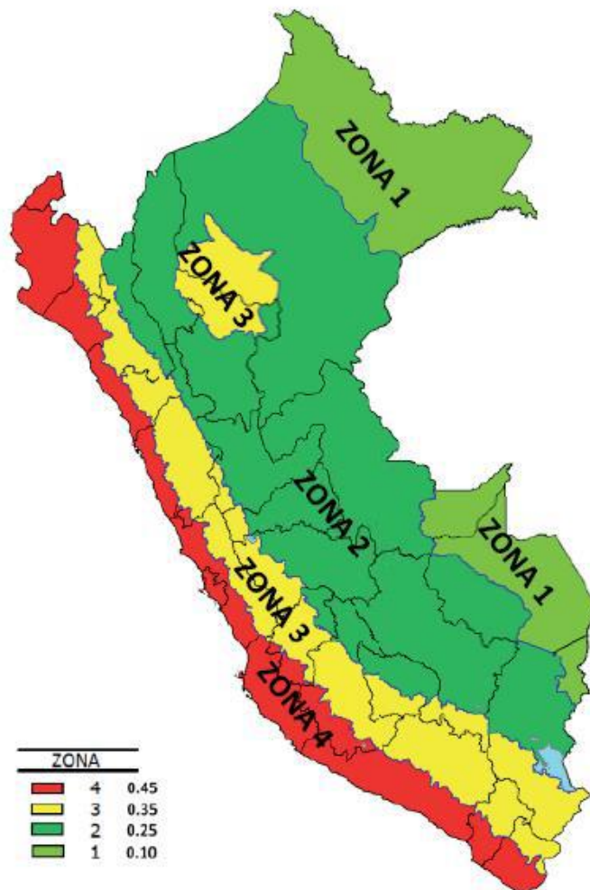
Figura 3-3: Mapa de peligro sísmico del Perú, de acuerdo con la norma de diseño sísmico.
