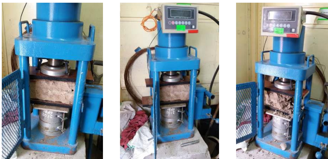
Figura 3-6: Colocación, aplicación de carga axial y falla de un espécimen típico de adobe.
