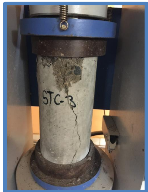
Rotura de probeta.
