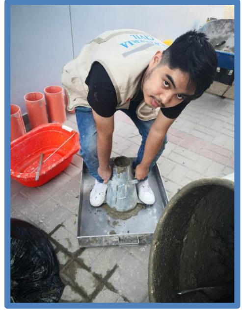
Ensayo de asentamiento.
