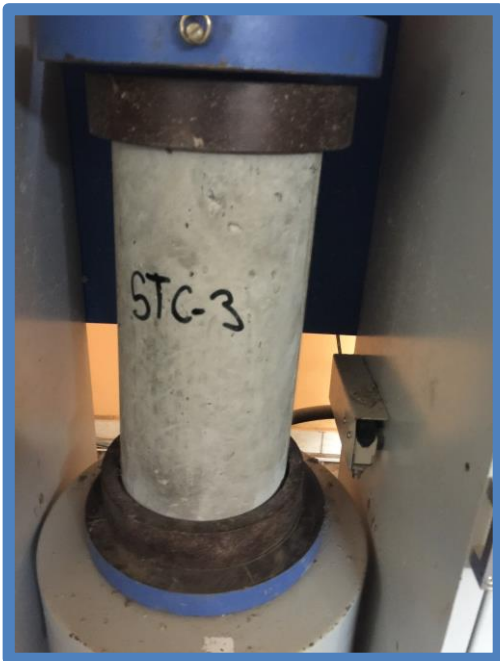
Colocación de probeta para ensayo.
