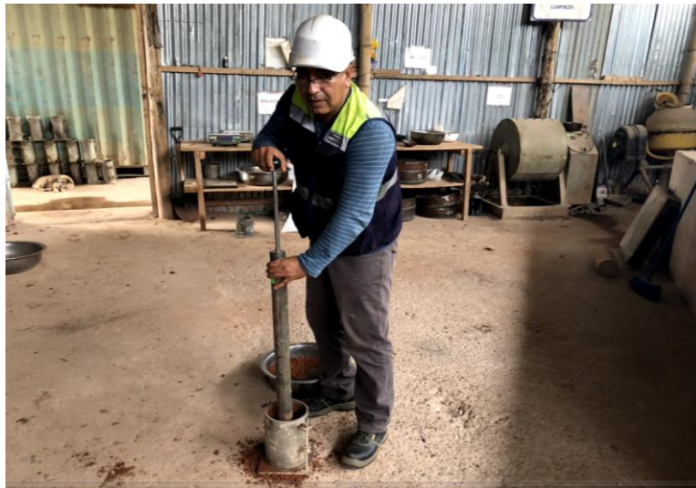
Imagen 9: Ensayo CBR compactación
