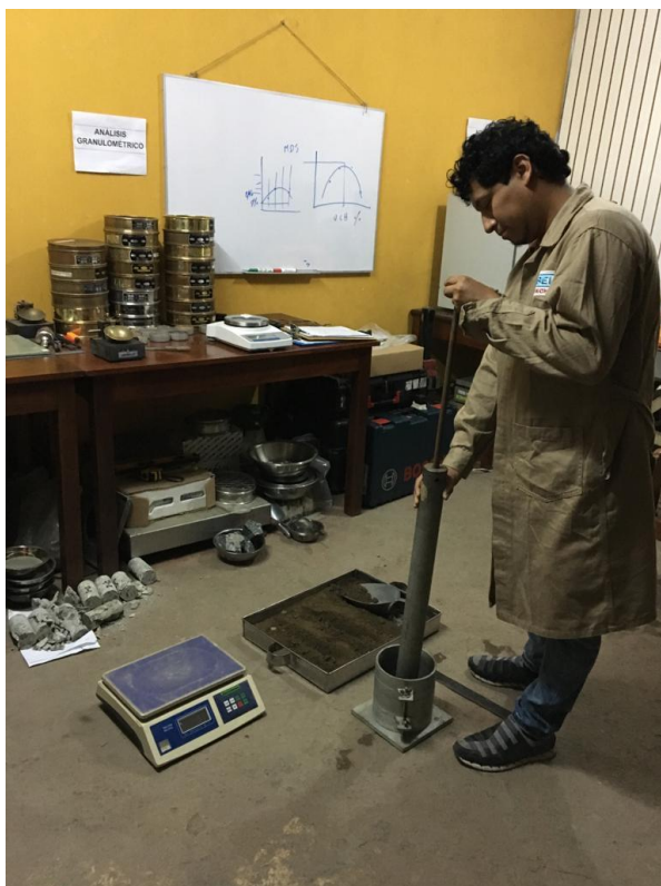
Figura 15. Golpes de compactación. Fuente: elaboración propia
