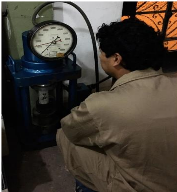
Figura 18. Prensa Hidráulica, proceso de rotura. Fuente: Elaboración propia.
