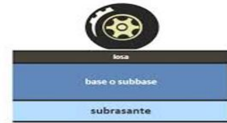
Figura 3. Elementos que conforman un pavimento rígido.
