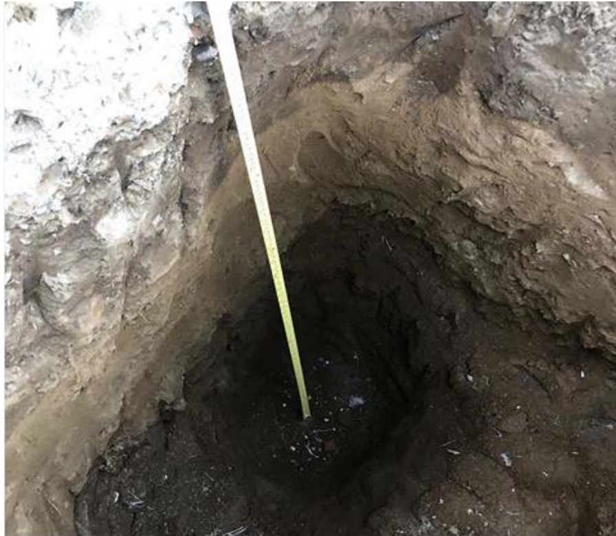
Figura 8. Calicata realizada en la zona de estudio.
