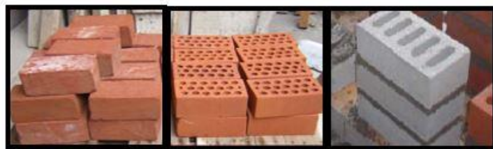
Figura 1. Unidades de Albañilería, Artesanal arcilla (Izquierda), Industrial Arcilla (Central – Lark) y Concreto (Derecha)
