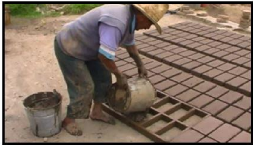
Figura 7. Fabricación artesanal de ladrillos de arcilla.
