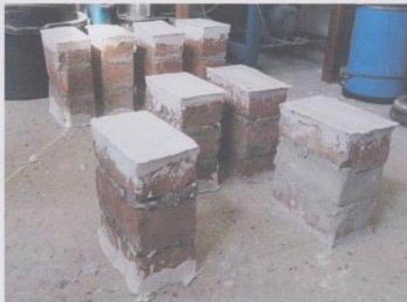
Figura : Pilas de albañilería capeados con yeso.
