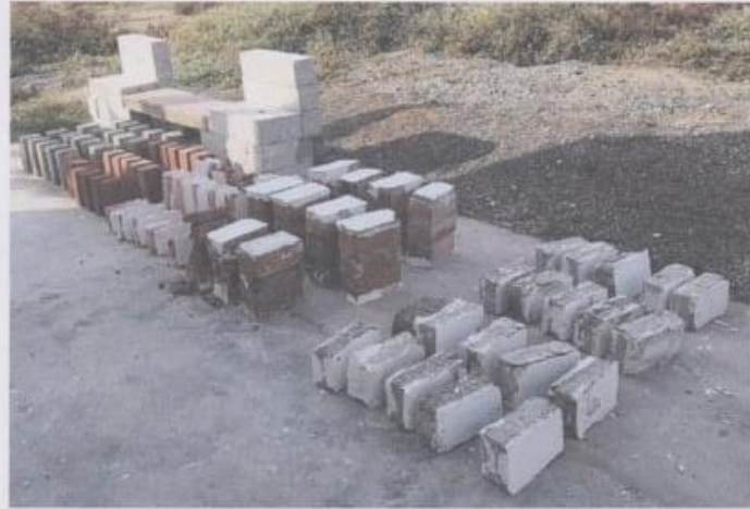
Figura: Unidades y pilas de albañilería después del ensayo a compresión.
