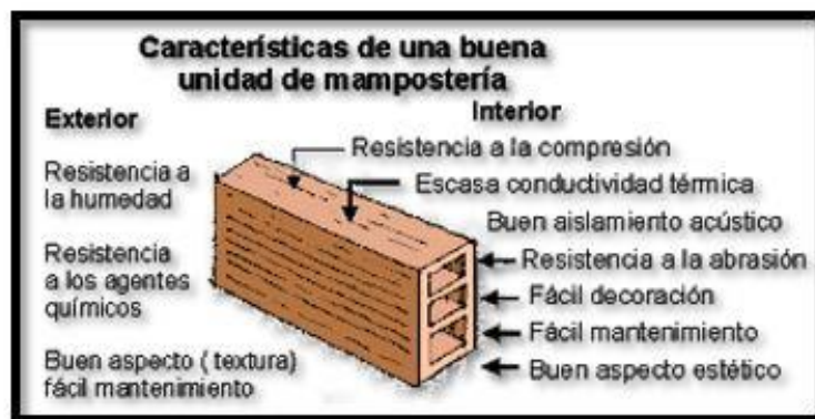
Figura 10. Características de una unidad de mampostería.
