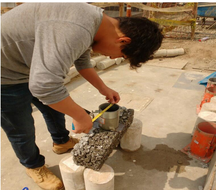
Prueba de permeabilidad mediante la filtración de un volumen de agua por un área determinada.
