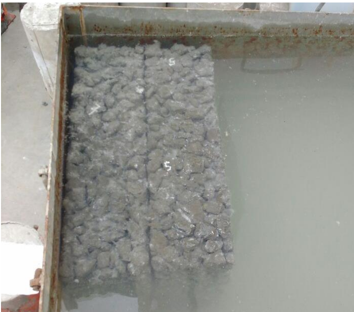
Curado vigas por 28 días para realizar el ensayo de flexión.
