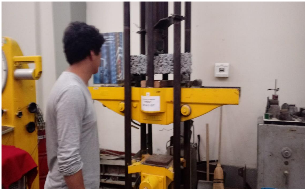
Figura 24: Ensayo de resistencia a la Flexión. Elaboración propia.
