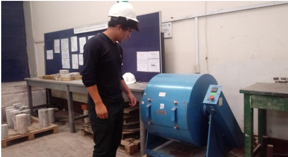
Figura 30: Realización de ensayo de desgaste en la máquina de los Ángeles. Elaboración propia.
