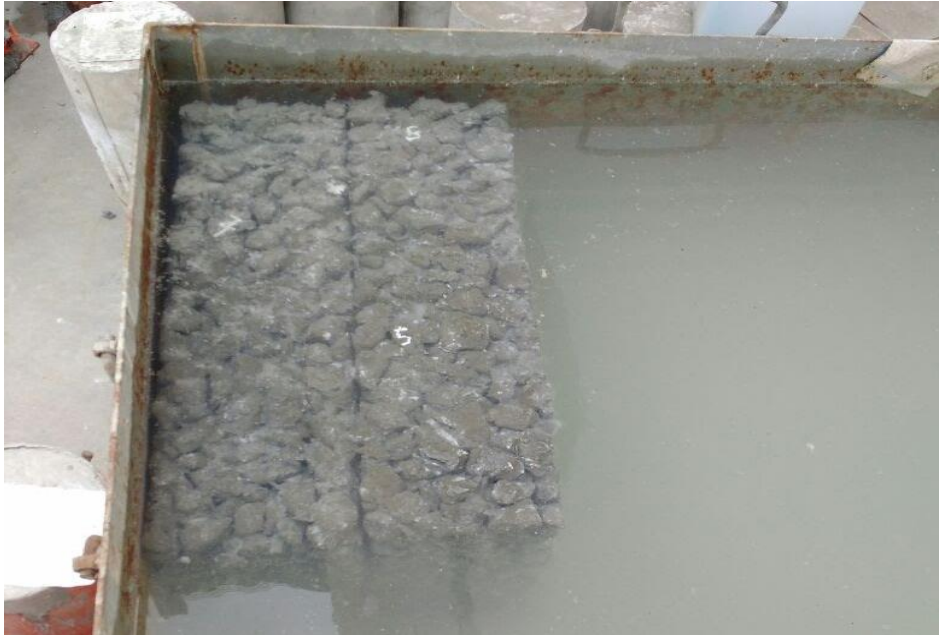
Figura 23: Curado de vigas. Elaboración propia.
