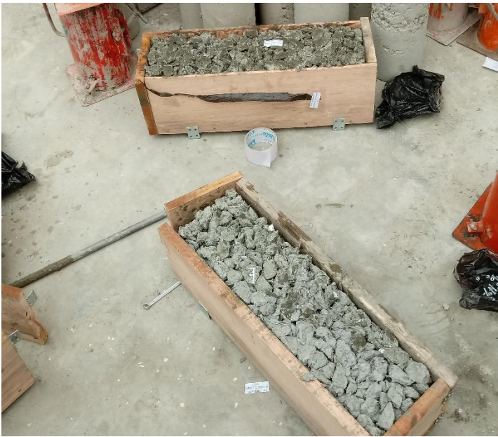
Desenfrado de vigas para su posterior curado.
