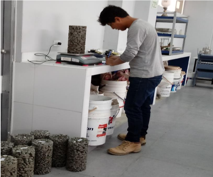
Pesado de espécimen de concreto permeable para el cálculo de peso específico del concreto.
