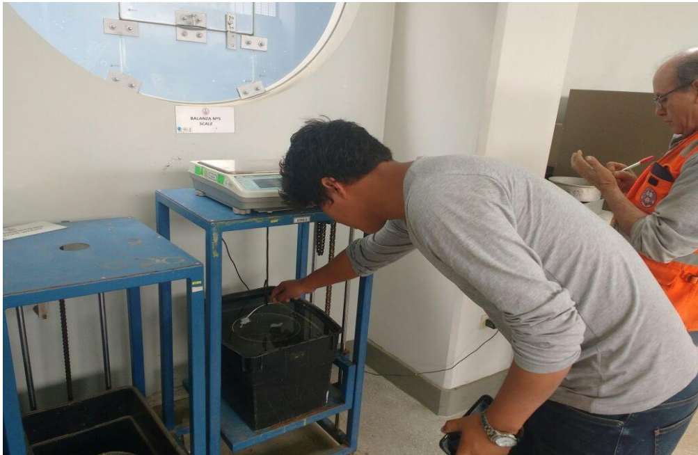
Figura 08: Peso de la muestra sumergido. Elaboración propia.
