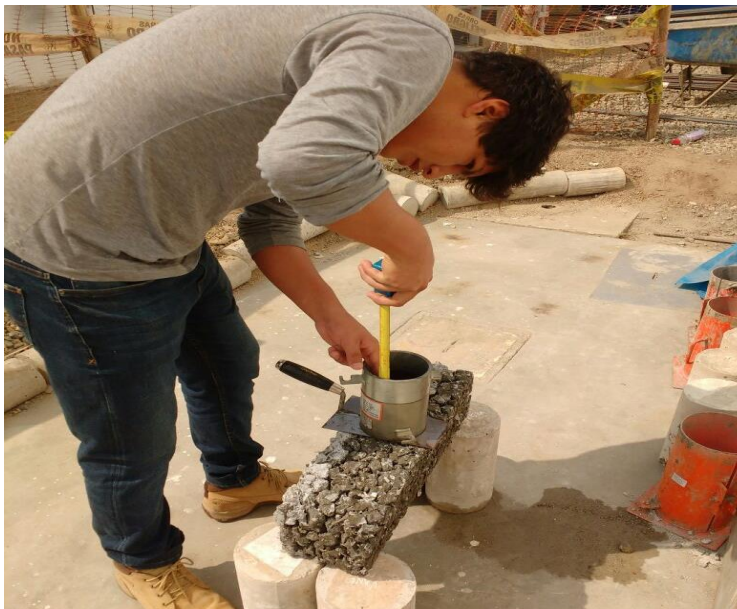
Prueba de permeabilidad mediante la filtración de un volumen de agua por un área determinada.
