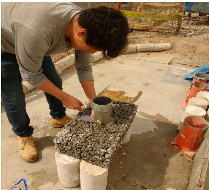
Figura 32: Prueba de permeabilidad. Elaboración propia.
