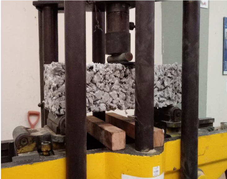
Realización de ensayo de ruptura a flexión del espécimen viga del concreto permeable
