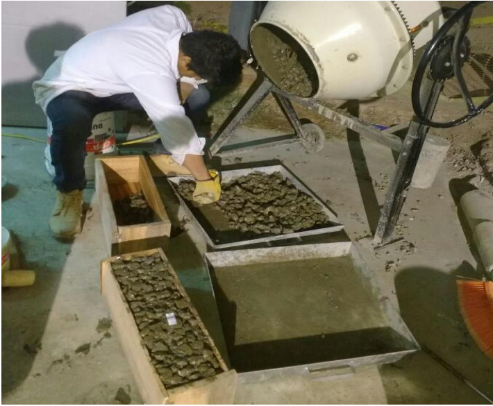
Realización de espécimen viga para el ensayo de flexión del concreto permeable
