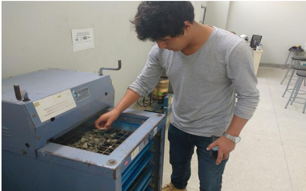
Figura 05: Tamizado del agregado grueso NTP 400.012. Elaboración propia
