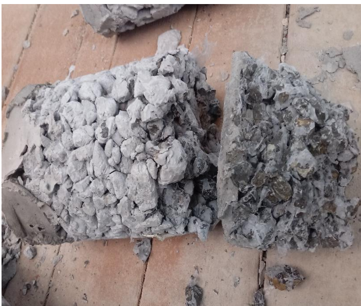
Espécimen cilíndrico fallada de concreto permeable con adición de 0.100% de LDPE
