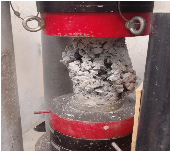
Falla de concreto permeable a compresión con adición de 0.050% de LDPE en forma de tiras.
