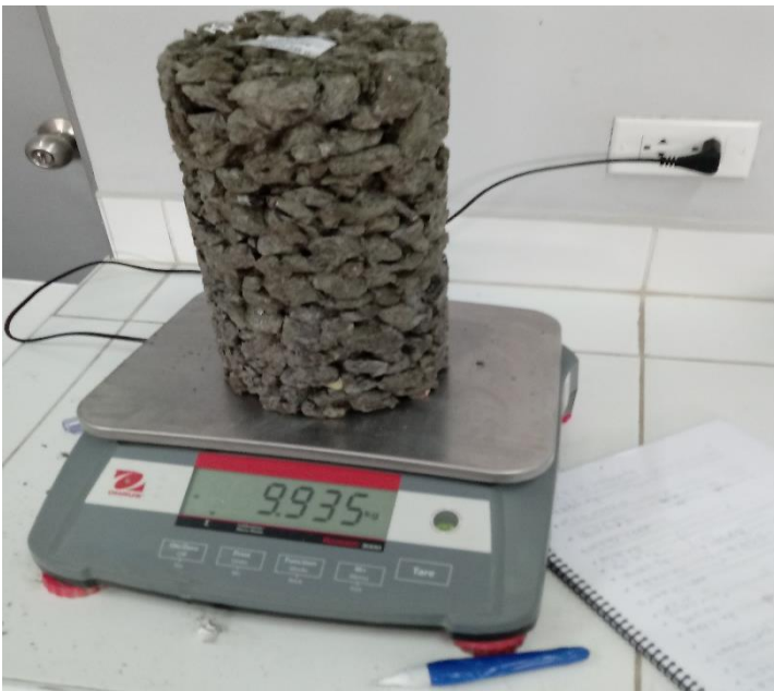
Peso de espécimen de concreto permeable para el cálculo de peso específico del concreto.
