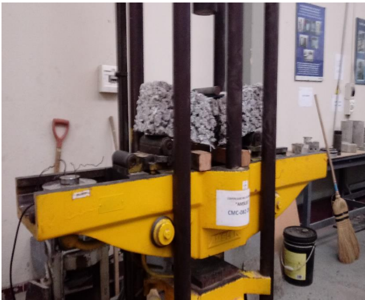
Falla del espécimen viga de concreto permeable con adición de 0.100% de LDPE en forma de tiras
