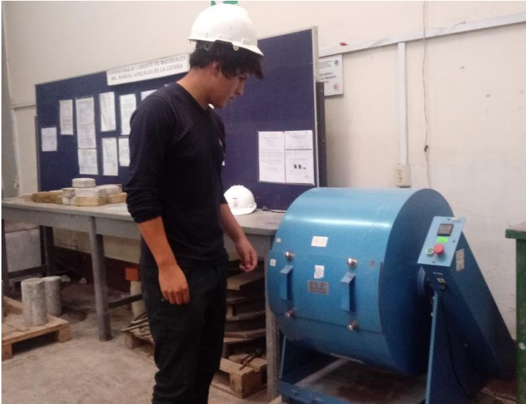
Ensayo de resistencia al desgaste mediante la máquina de los Ángeles del concreto permeable
