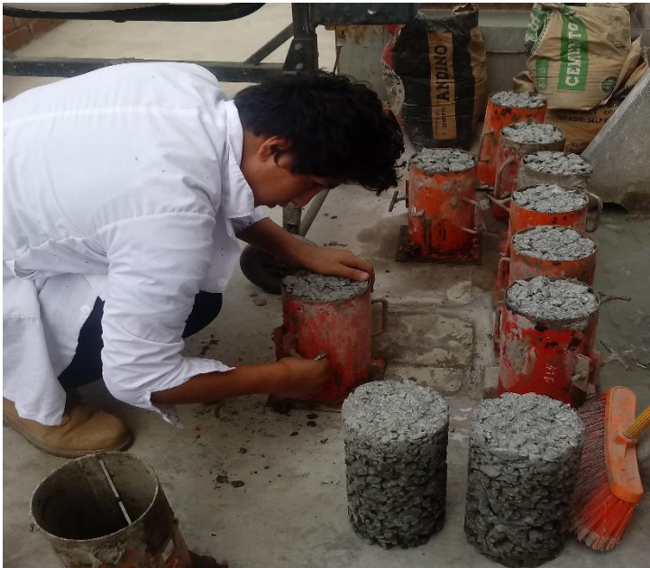
Desencofrado de probetas de concreto permeable para su posterior curado.
