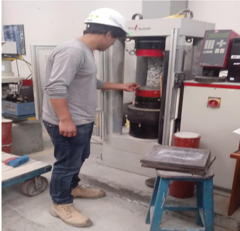
Figura 16: ensayo de compresión de probeta con carga uniaxial. Elaboración propia.
