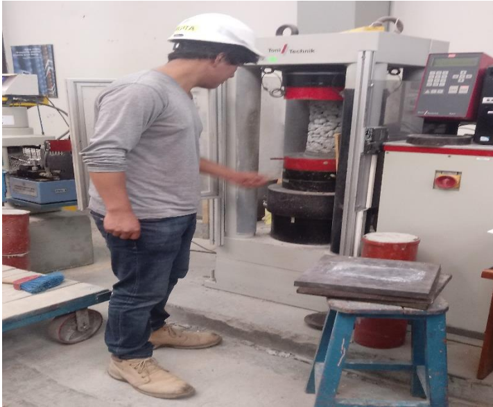
Realización de ensayo de compresión del concreto permeable
