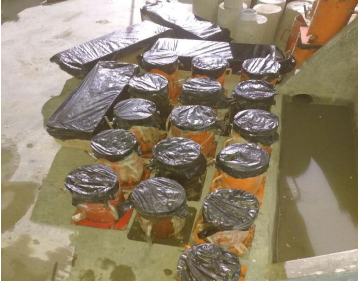
Cubierta de probetas con plástico por los primeros 36 horas.
