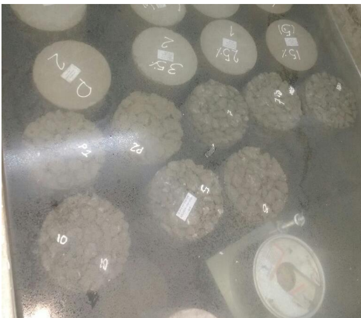
Curado de probetas por 28 días en la posa de curado
