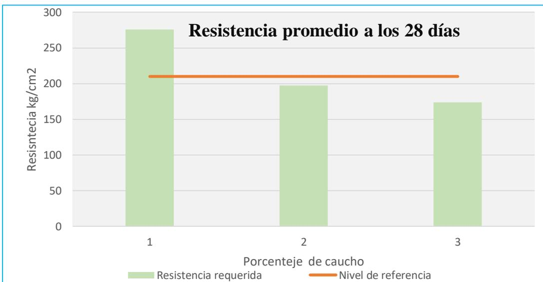
Figura 15. Distribución de la resistencia a la compresión. El patrón y está por encima del nivel de referencia pero con 5 % y 10 % están por debajo de la resistencia requerida.
