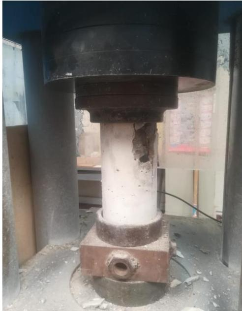
*Figura 4.* Prueba a las resistencias para compresión Fuente: Elaborado propio
