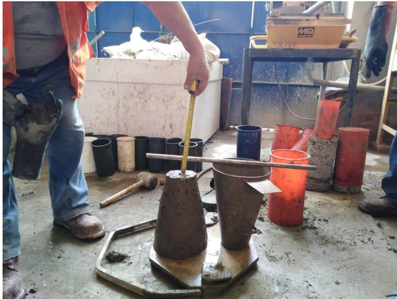
*Figura 1.* Ensayo del slump para medir la trabajabilidad del concreto
