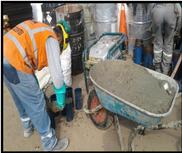
Figura 52. Preparación de probetas y prueba de slapm.
