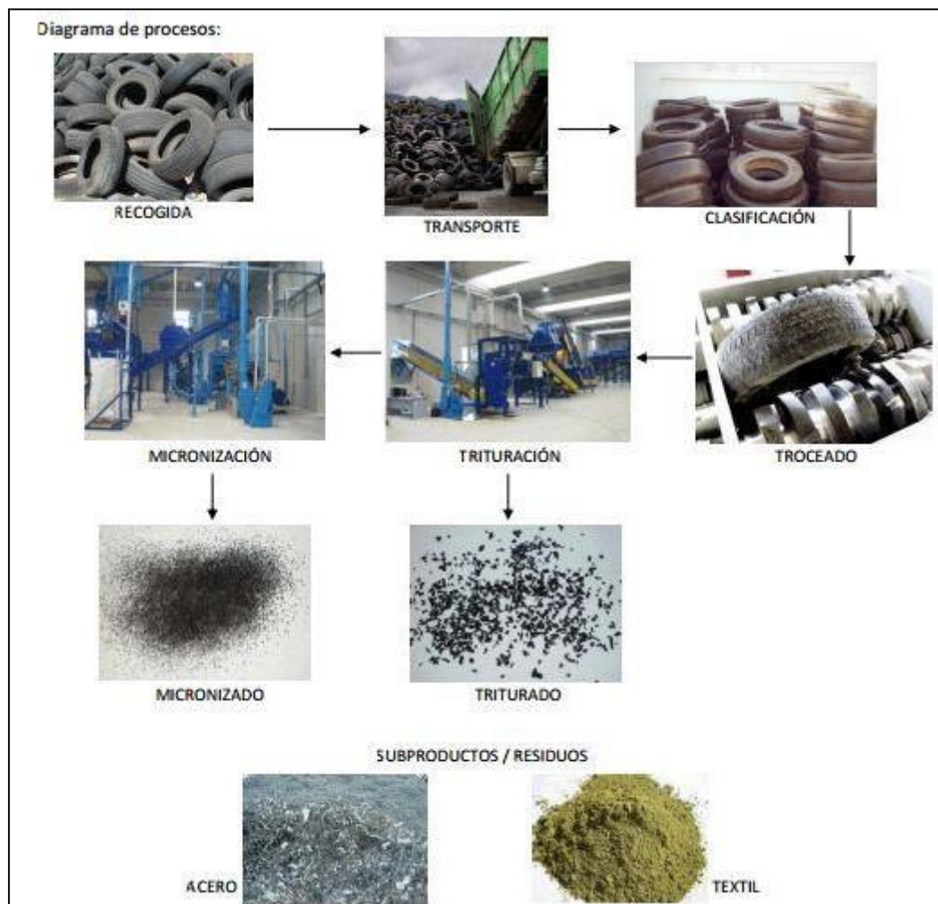
Figura N° 8 Procedimiento mecánico Fuente: http://www.rubberizedasphalt.org/
