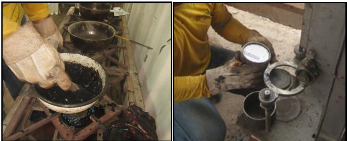
Figura N° 27 Colocación de mezcla asfáltica para ser golpeada 75 veces
