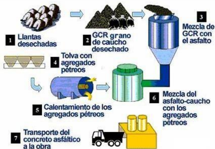
Figura N° 11 Fases del procedimiento de mezcla asfáltica con polvo de Caucho de NFU
