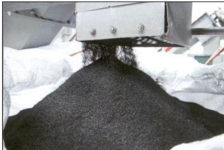
Figura N° 10 Producto final de molienda de desechos de neumáticos Fuente: Conacyt
