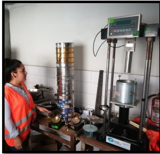
Figura N° 18 tamizado de agregados
