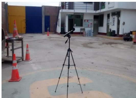
Figura N° 09: Monitoreo de ruido en el área de maniobra
