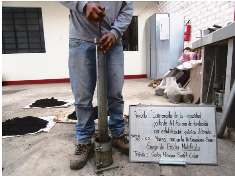
Figura 28. Ensayo de Proctor Modificado.
