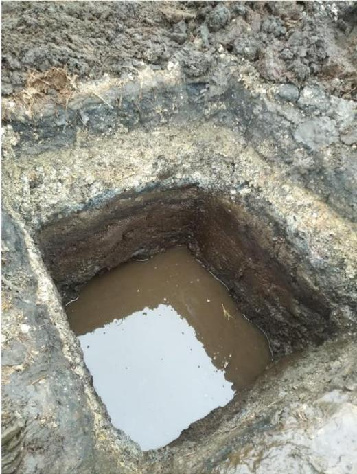
*Figura 10.* Calicata C-2, se aprecia la Profundidad excavada y la presencia del nivel freático.
