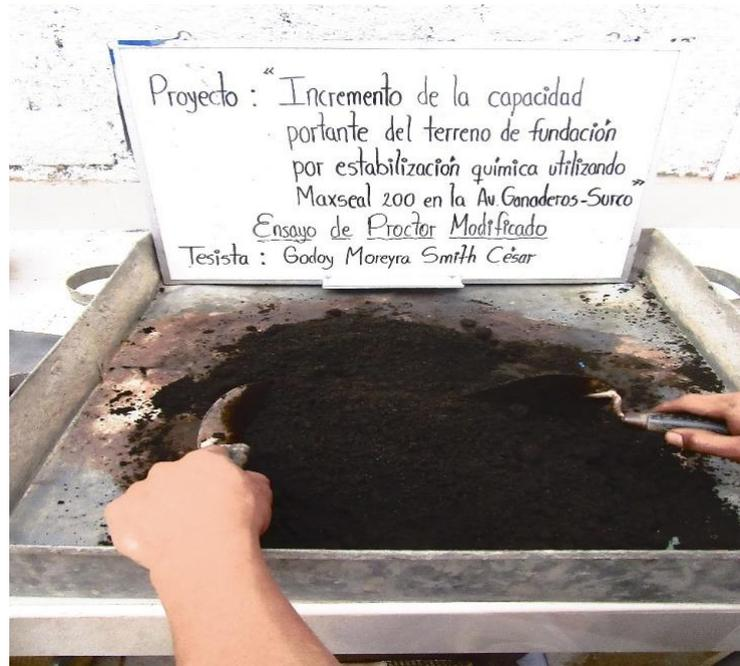
Figura 24. Ensayo de Proctor modificado de calicatas C-1 y C-2.
