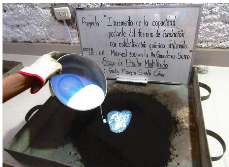
Figura 25. Ensayo de Proctor modificado con adición de 6% del estabilizador químico MAXX-SEAL 200.
