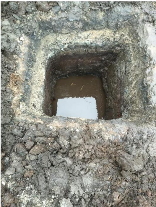
*Figura 8.* Calicata C-1, se aprecia la Profundidad excavada y la presencia del nivel freático.
