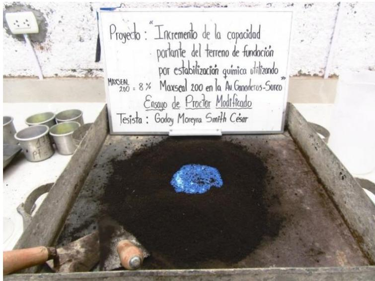
Figura 26. Ensayo de Proctor modificado con adición en 8% del estabilizador químico MAXX-SEAL 200.
