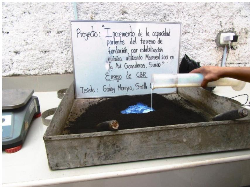
Figura 29. Ensayo de CBR muestras de suelo natural.
