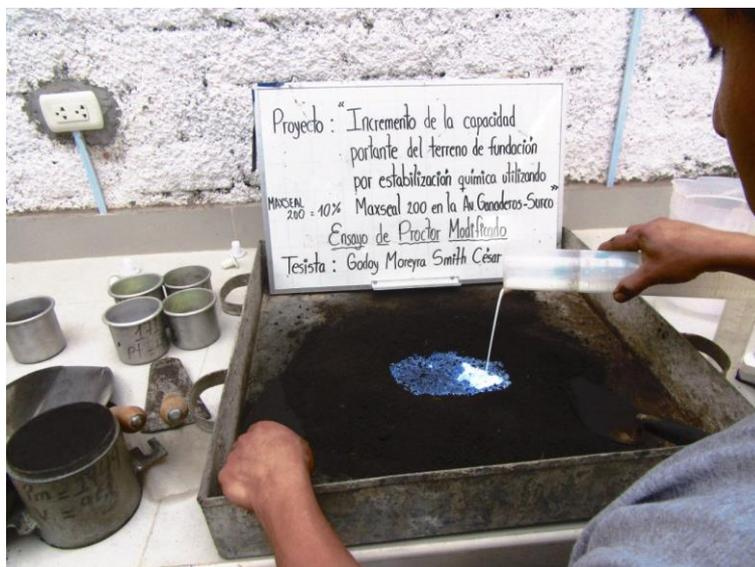
Figura 27. Ensayo de Proctor modificado con adición en 10% del estabilizador químico MAXX-SEAL 200.
