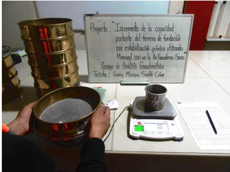
Figura 22. Ensayo de granulometría por tamizados de calicata C-1.
