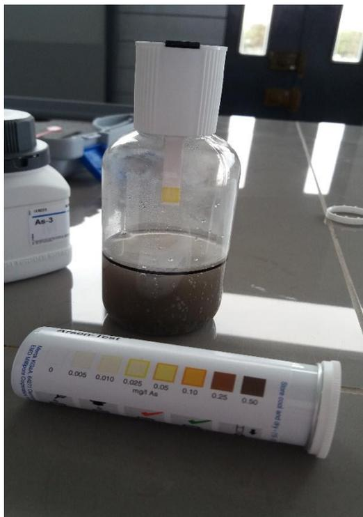
Resultados de los análisis de la concentración de Arsénico, indicando la cinta colorimétrica 0,05 mg/l.
