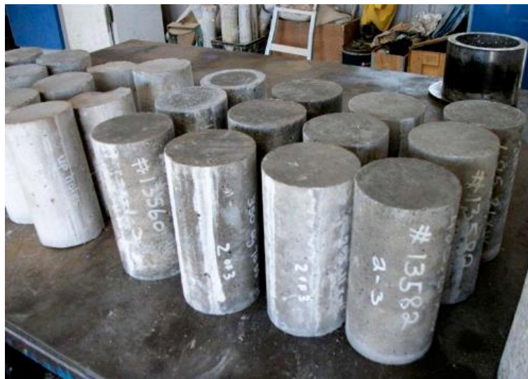
Figura N° 7: Testigos o probetas de concreto de 6” x 12”.
