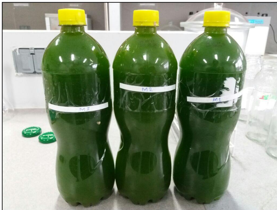
Figura N° 20: Botellas llenas de agua ya tratadas con las macrófitas Jacinto y Lenteja de agua, de cada pecera, para tomar el pH, T°
