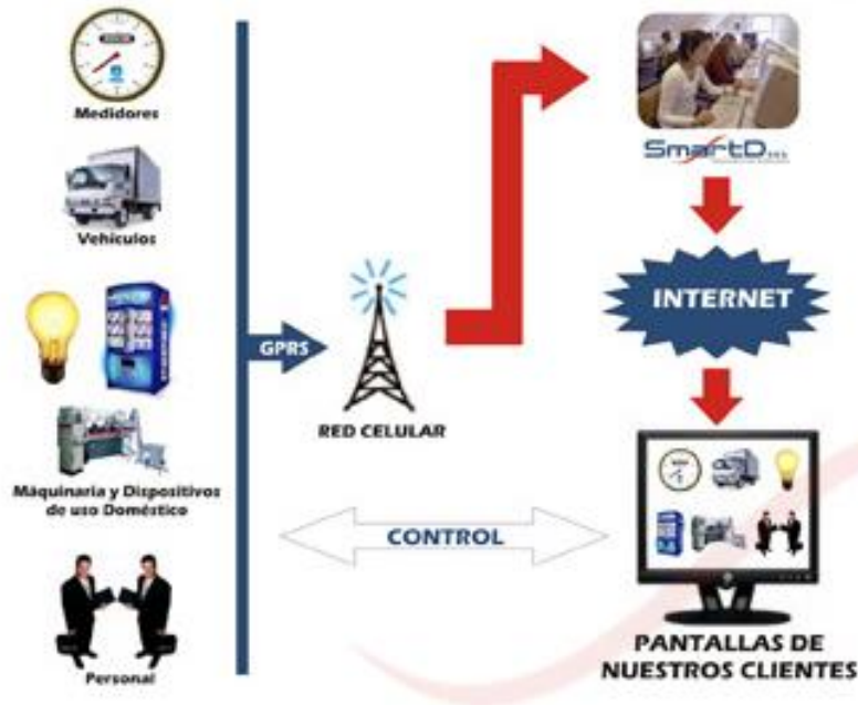
Figura 1 Esquema del Funcionamiento Telemetría. Ledezma 2011
