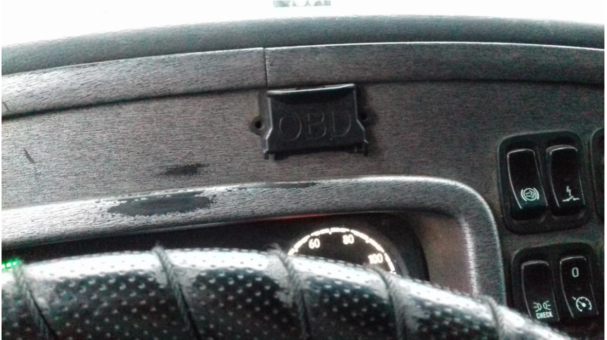
Figura 13 Tablero del bus Scania conector del OBD
