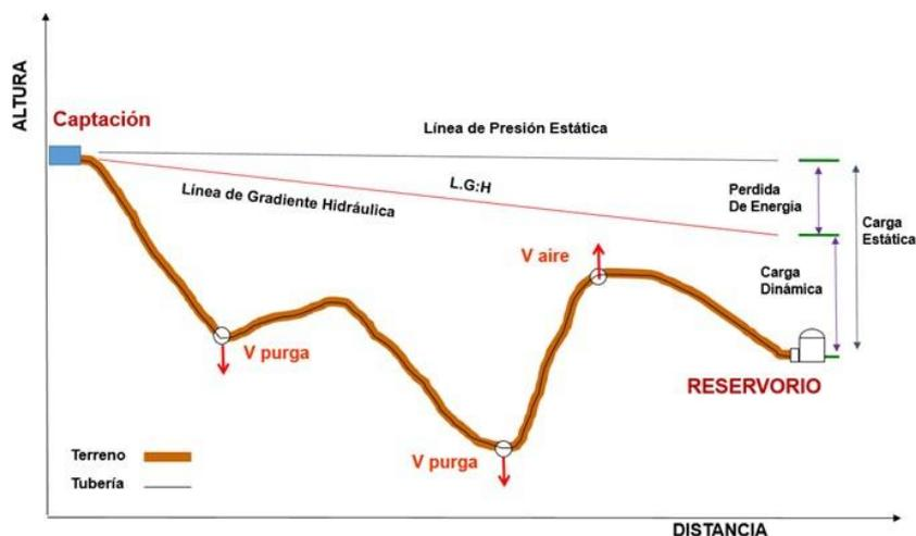
FIGURA 07. Línea de Conducción
