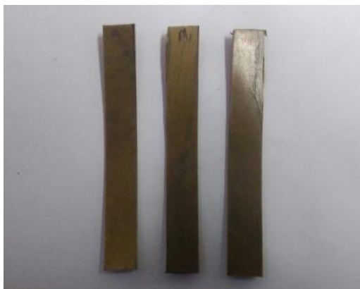
Foto N°19: Probetas de flexión después del ensayo.
