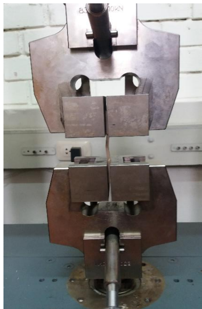
Foto N°15: Prueba de tracción
