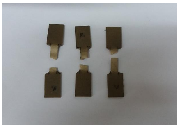
Foto N°16: Probetas de tracción después del ensayo.
