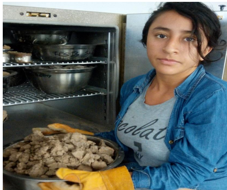
Figura 69 : muestra retirada del horno después d 24h.
