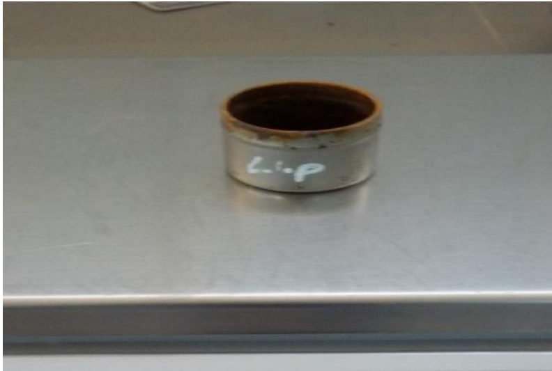
Figura 74: peso de la porción extraída de material compactado.
