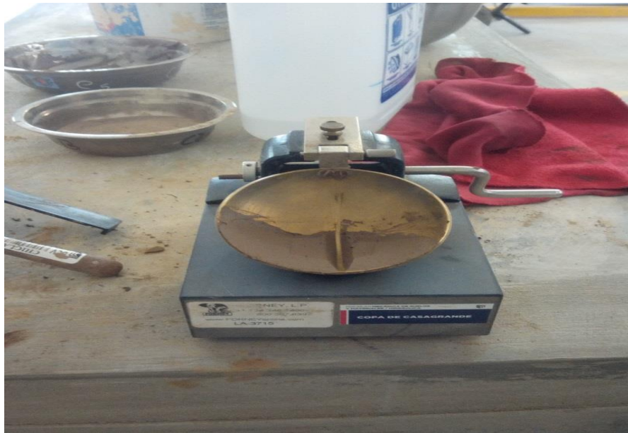
Figura 58: Muestra del suelo ranurado por el acanalador
