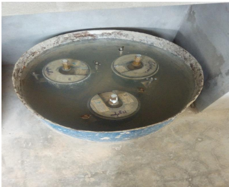
Figura 84: muestra de los moldes sumergido en agua
