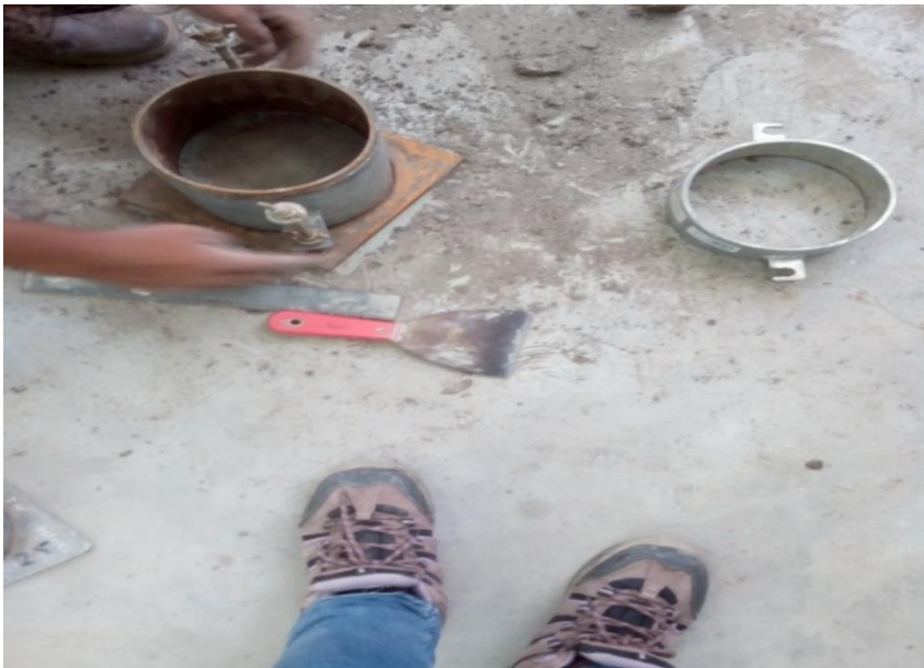
Figura 79: molde para compactar.
