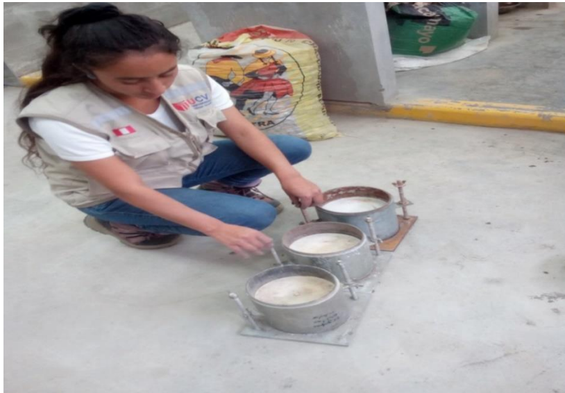
Figura 83: muestras para dejar sumergir en el agua durante 4 días.
