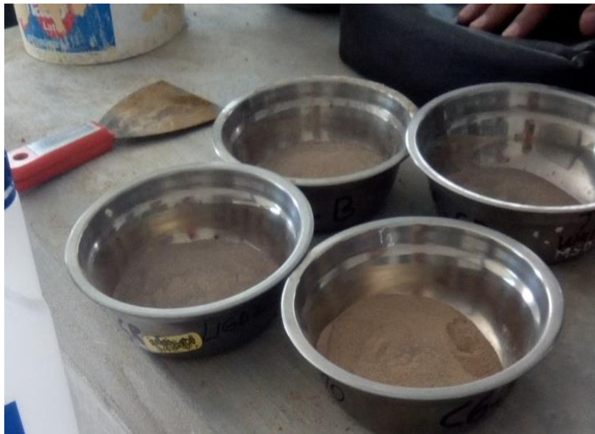
Figura 55: Muestra pasada por malla #40
