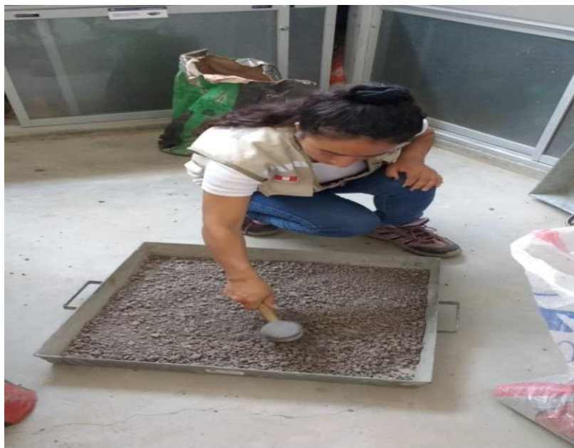
Figura 75: Material triturado para pasar por la malla # 4.
