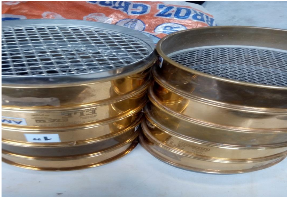
Figura 50: tamices para el ensayo de granulometría.
