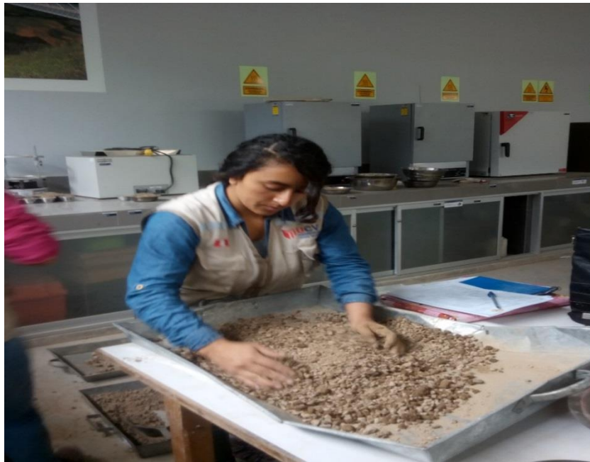
Figura 72: mezcla de material para que alcance humedad
