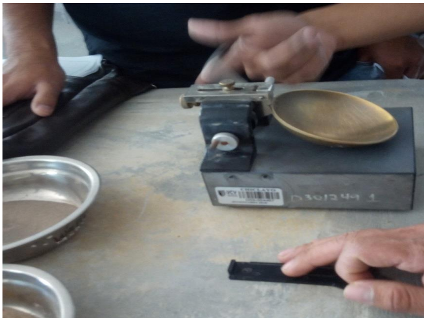
Figura 56: proceso de calibrado de la copa casa grande
