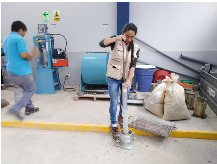
Figura 73: compactación de material de 5 capas a 56 golpes por capa.
