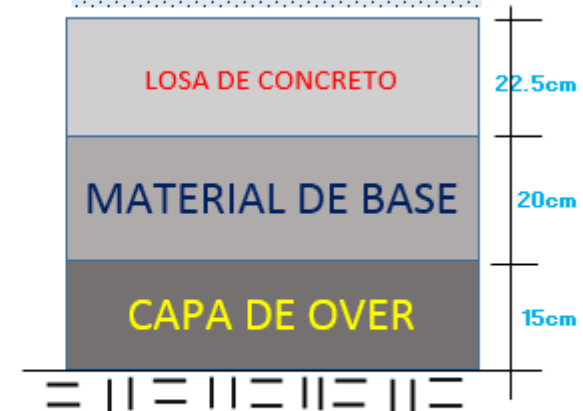
SECCIÓN TÍPICA DE PAVIMENTO RÍGIDO
