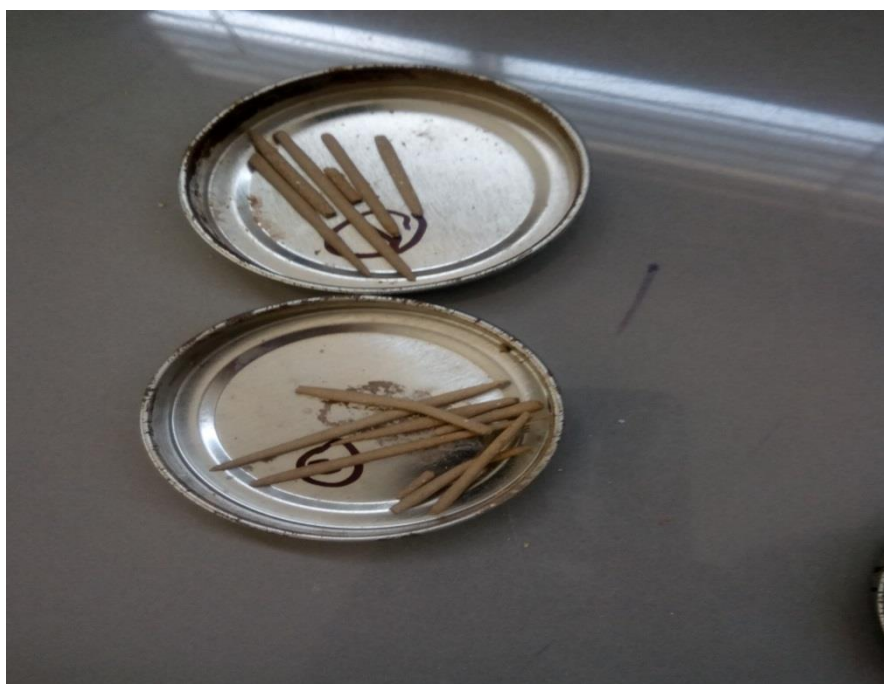
Figura 67: Peso de suelo después de pasada las 24 h en el horno.
