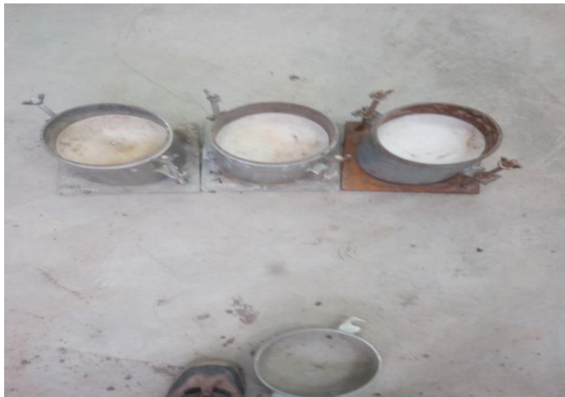
Figura 82: muestras compactadas de 12g, 25g, y 56g
