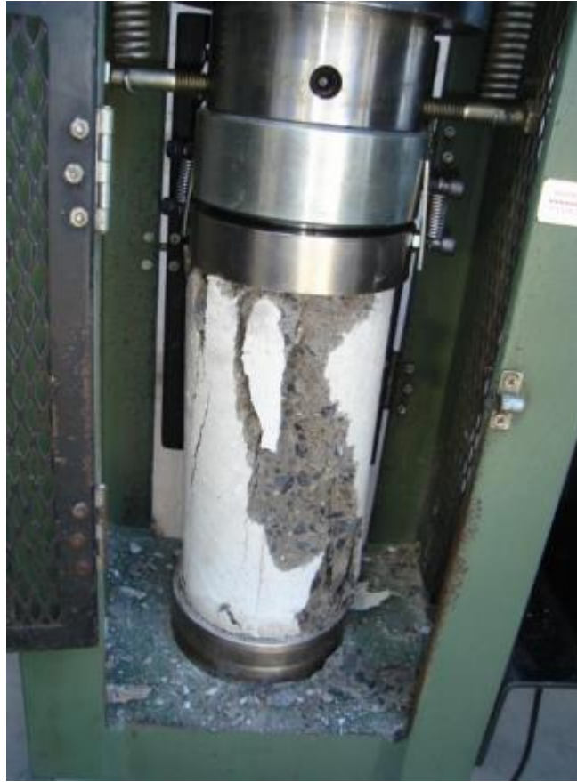
Figura 6. Ensayo a compresión del concreto en su estado límite
