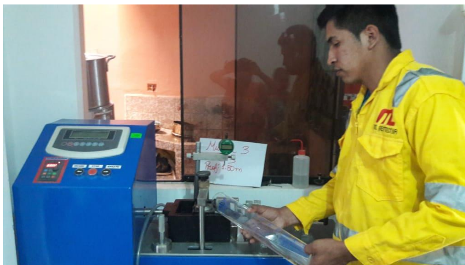
Figura 24. Desarrollo del ensayo de corte directo. (Fuente: Propio tesista, 2019)
