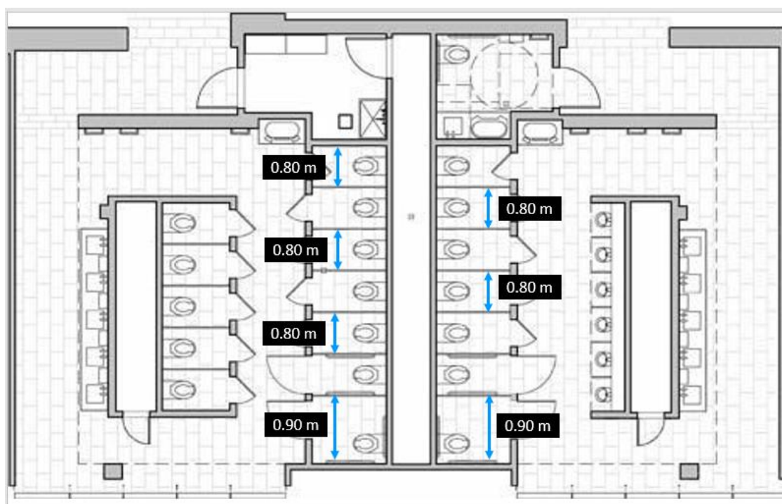
Figura 89 Distribución en los servicios sanitarios y vanos
