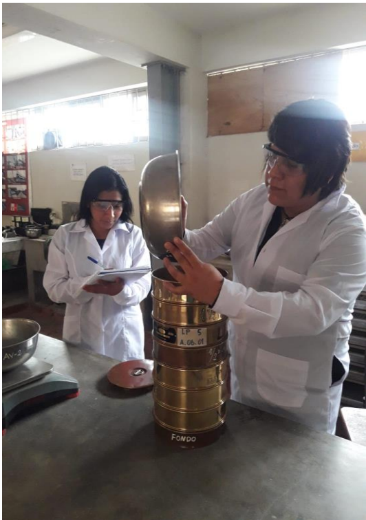
Figura 15: Insertando muestra del agregado en los tamices. Elaboración propia.
