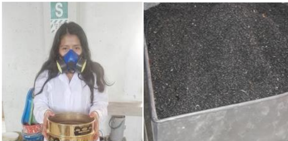
Figura 32: Tamizado de la limalla de acero. Elaboración propia.
