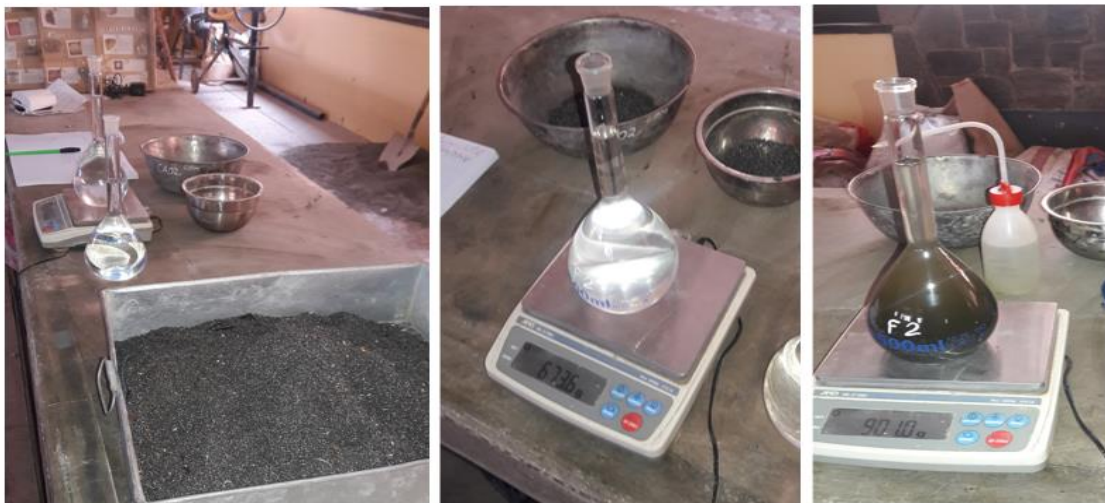
Figura 30: Ensayo para determinar el peso específico de la limalla de acero con el picnómetro. Elaboración propia.
