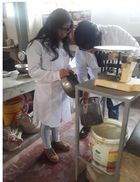
Figura 23: Pesado de la muestra dentro de la canastilla sumergida. Elaboración propia.
