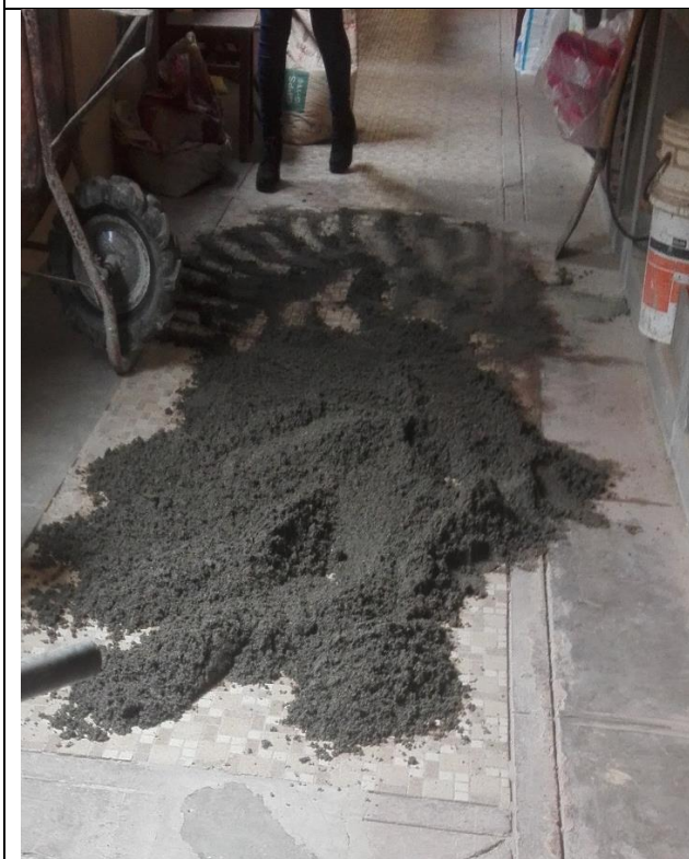
Figura 13: Secado del agregado fino. Elaboración propia.
