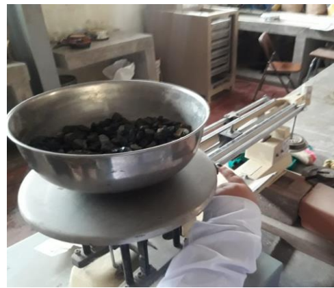
Figura 21: Pesado de la muestra secada superficialmente con una franela. Elaboración propia.
