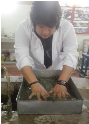
Figura 18: Lavado del agregado. Elaboración propia.
