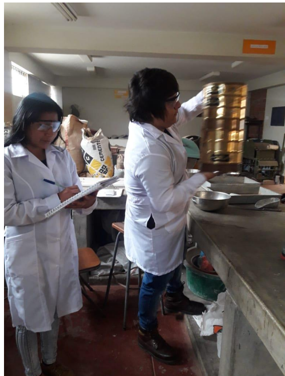
Figura 16: Tamizado del agregado grueso. Elaboración propia.
