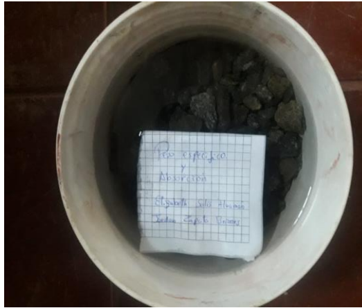
Figura 19: Saturación de la muestra en un recipiente por 24 horas. Elaboración propia.
