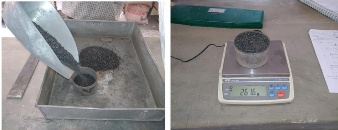
Figura 31: Ensayo para determinar el peso unitario de la limalla de acero. Elaboración propia.
