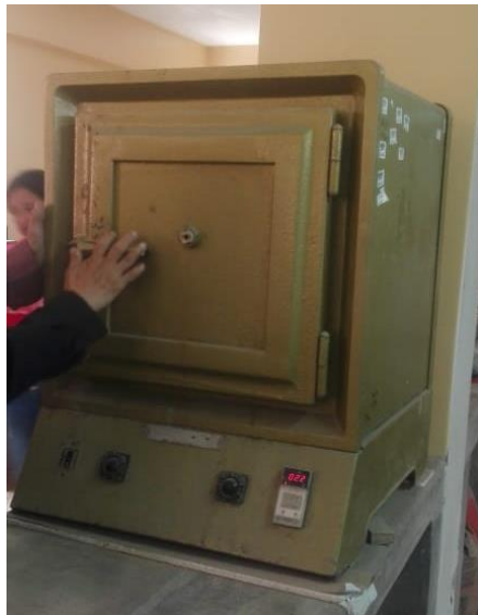
Figura 24: Colocación de la muestra del agregado grueso en el horno para su secado. Elaboración propia.
