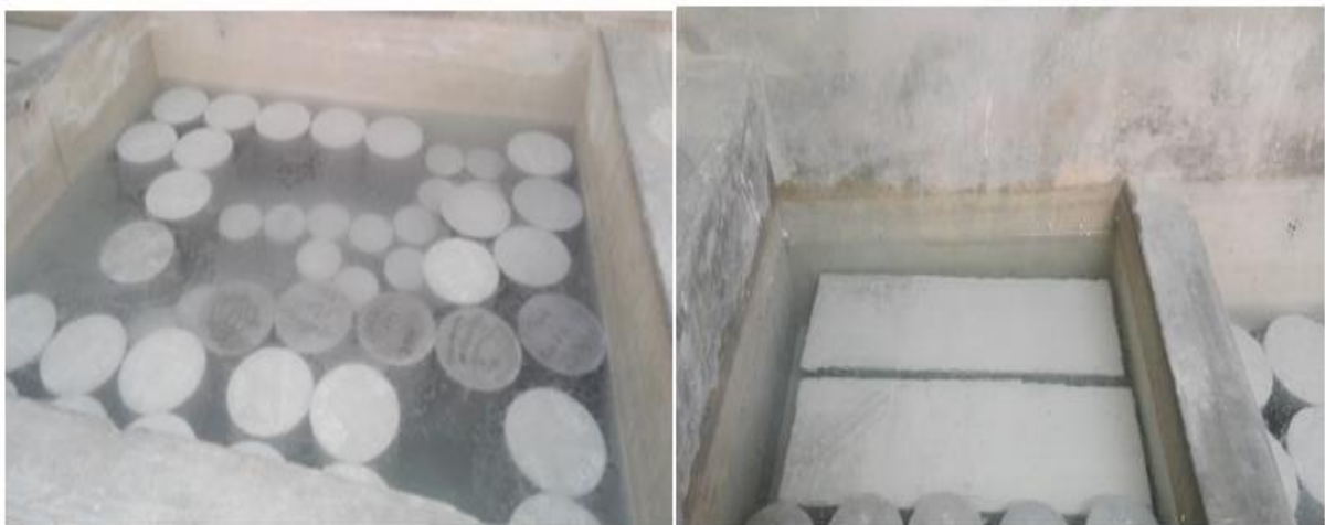
Figura 33: Probetas cilíndricas y prismáticas en proceso de curado. Elaboración propia.
