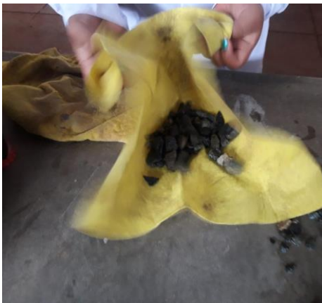
Figura 20: Secado de la muestra saturada con una franela. Elaboración propia.
