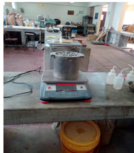
Figura 28: Pesado del contenido del recipiente metálico. Elaboración propia.
