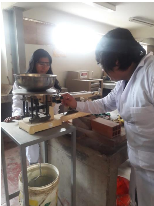
Figura 22: Calibración de la balanza con las canastillas metálicas. Elaboración propia.
