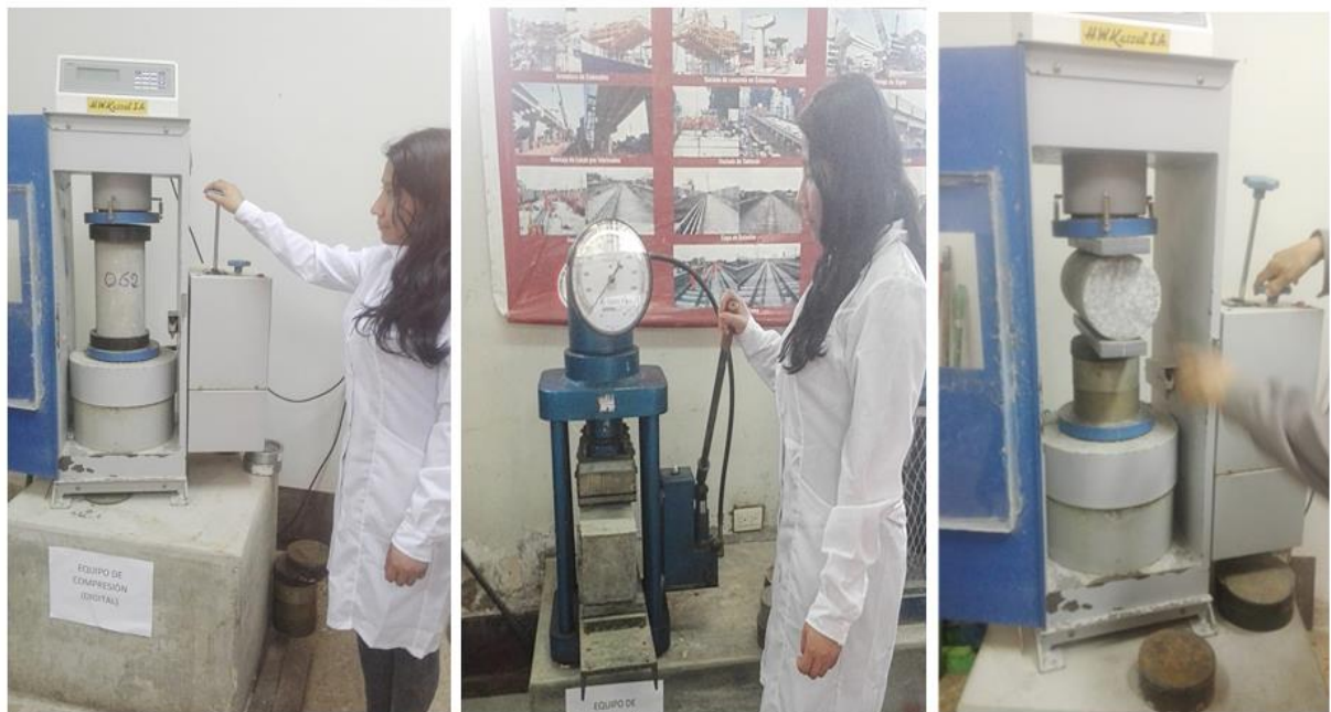
Figura 35: Ensayo de compresión, flexión y tracción indirecta. Elaboración propia.
