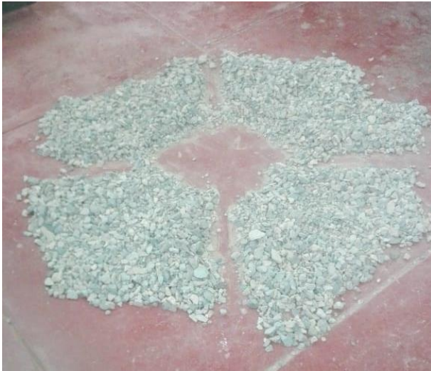
Figura 25: Cuarteo del agregado grueso. Elaboración propia.
