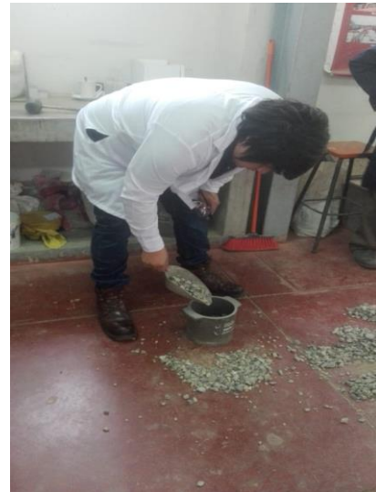
Figura 26: Colocación de la muestra en el recipiente con un cucharón a una altura de 2”. Elaboración propia.
