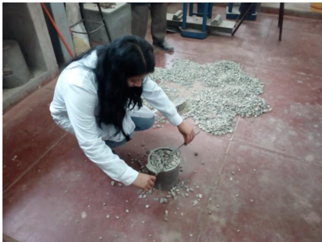
Figura 27: Emparejar el contenido del recipiente con una regla metálica. Elaboración propia.
