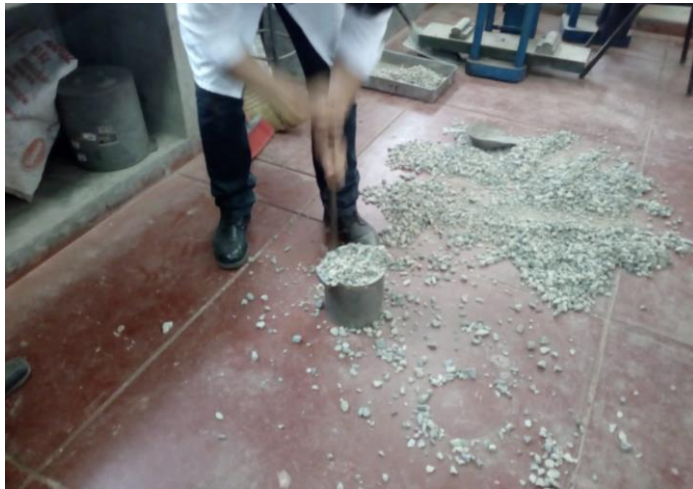
Figura 29: Apisonado de la muestra con 25 golpes uniformemente con una varilla de acero. Elaboración propia.
