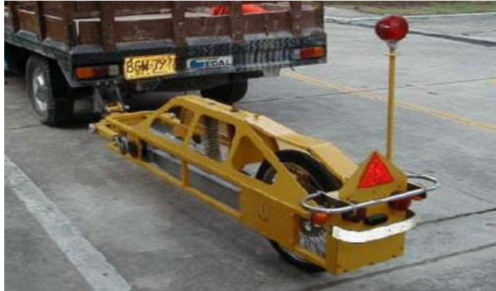
Figura 6 El Analizador de Perfiles Longitudinales (APL) Fuente: (Onofre, Sánchez y Santiago, 2008, p. 26)
