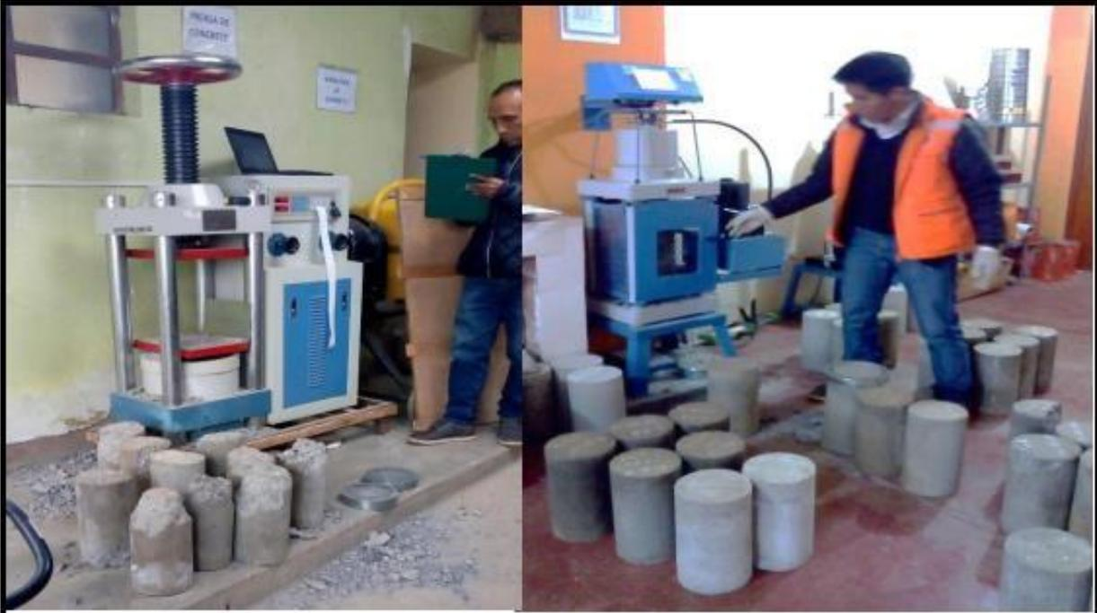
DESCRIPCIÓN: ROTURA DE PROBETAS DE PARTE DE LA SUPERVISIÓN Y SE ASISTIÓ A LA ROTURA DE PROBETAS DEL CONTRATISTA MLS, VERIFICANDO RESULTADOS EN AMBOS CASOS POR ENCIMA DE LOS 280KG/CM<sup>2</sup>.
