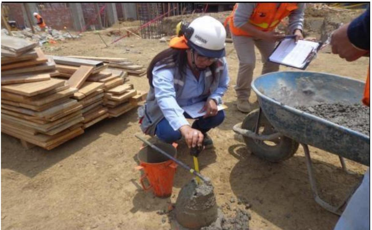
DESCRIPCIÓN: VERIFICACION DEL SLUMP DE CONCRETO PARA VACIADO DE COLUMNAS DEL 2DO PISO DEL PABELLÓN 1.
