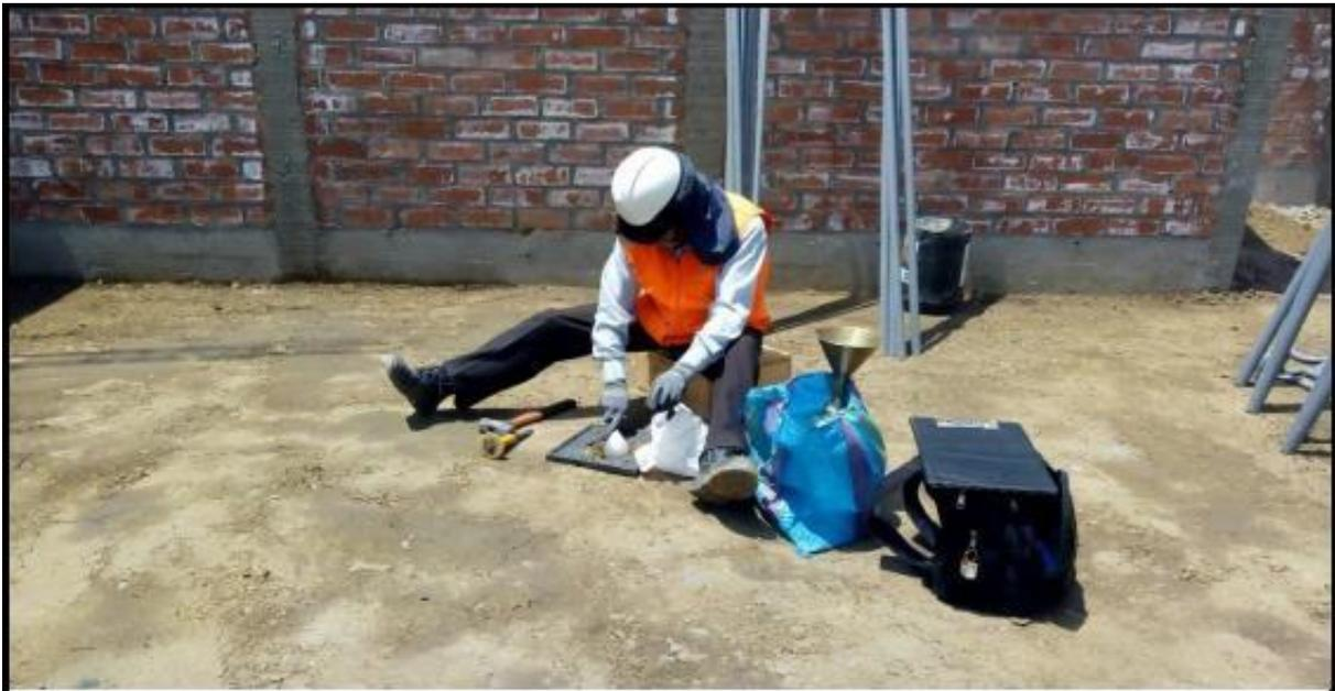
DESCRIPCIÓN: VERIFICACIÓN DEL ENSAYO DE DENSIDAD DE CAMPO EN EL PABELLON 6, PREVIO AL VACIADO DE FALSO PISO.
