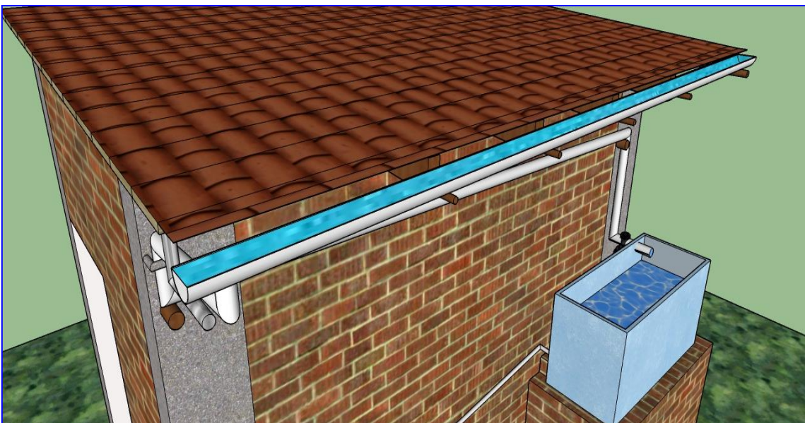
Fig. 12 Cobertura con teja andina y recolección de aguas pluviales.
