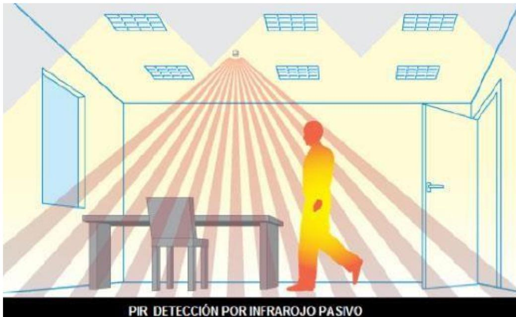
**Imagen 3.** *Funcionamiento de los detectores PIR*
