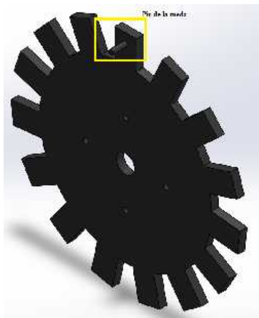
Rueda dentada para el sensor CKP. Fuente: Propia
