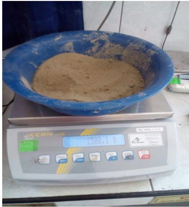
Foto N° 13: Se prepara la muestra, para el tamizado.
