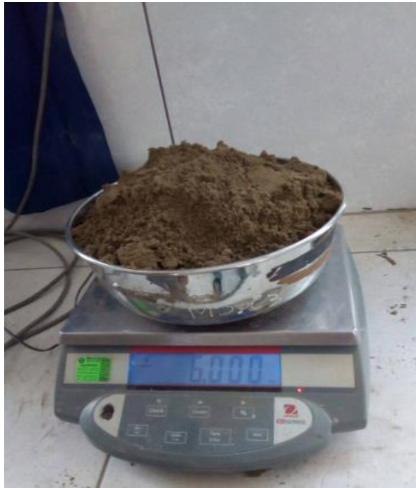
Foto N° 19: Pesando las muestras para luego realizar el Proctor.
