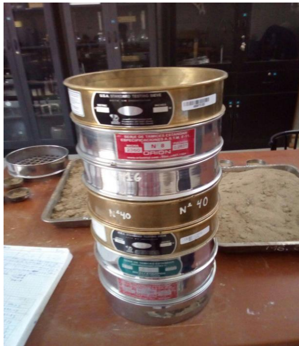
Foto N° 13: Se prepara la muestra, para el tamizado.
