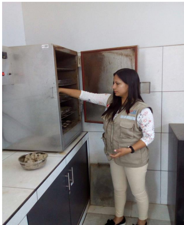
Foto N° 12: Las muestras se encuentran en el horno para su granulometría.
