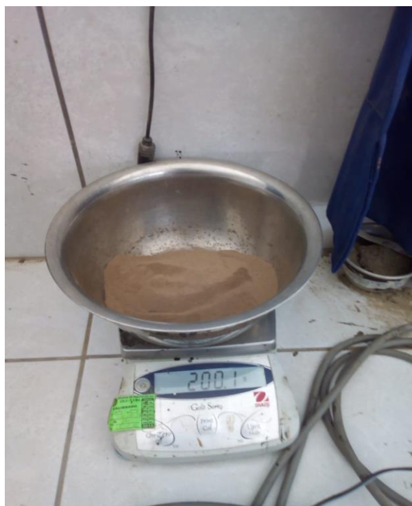
Foto N° 15: Pesamos el material en seco de 200 gr.
