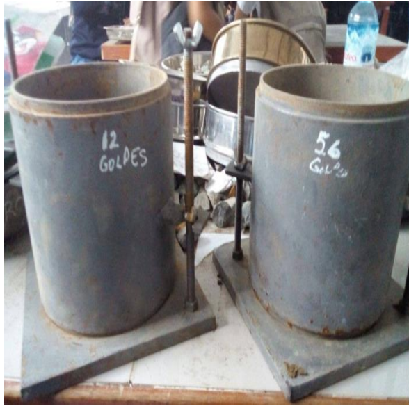
Foto N° 21: El molde y la muestra para sumergirlo en el agua.
