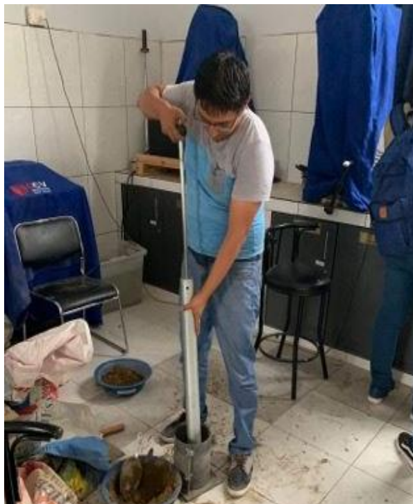
Foto N° 20: Se le realiza 56 golpes y 12 golpes por cada 5 capas.
