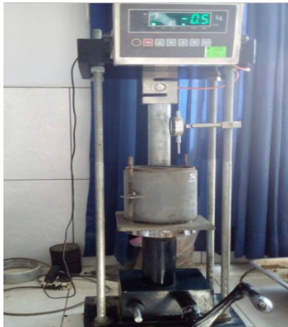
Foto N° 22: El molde y la muestra utilizando el equipo de penetración.
