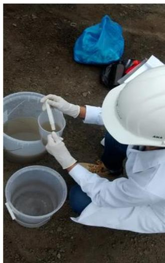
Figura 31. Toma de muestra de agua residual y medición de parámetros de campo.
