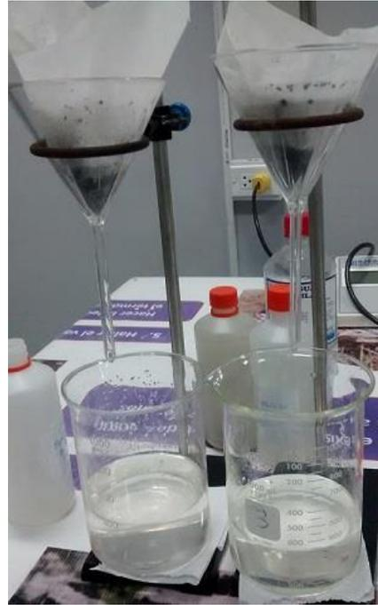
Figura 37. Filtración con carbón activado granular, a la derecha utilizando la bomba de vacío. A la izquierda, filtración con embudos de vidrio.
