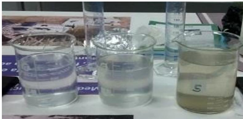
Figura 38. Comparación de agua residual, al extremo derecho, y en el centro y lado izquierdo después de la filtración con carbón activado.
