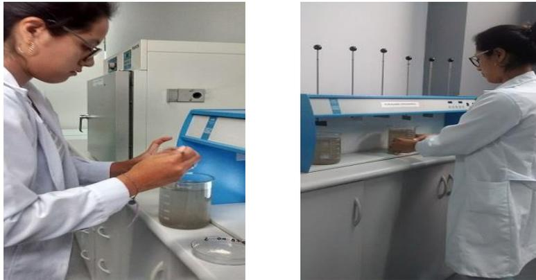
Figura 35. Colocación de jarras en el equipo y adición de *Moringa oleífera*.
