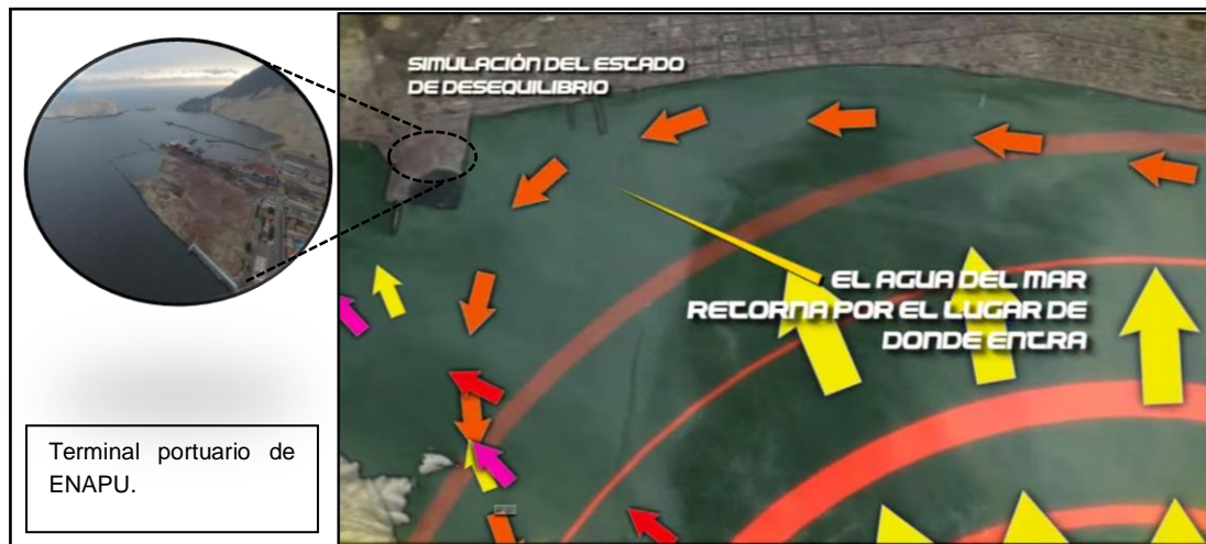
FIGURA 60: DINAMICA MARINA DESPUES DE LAS INFRAESTRUCTURAS PORTUARIAS
