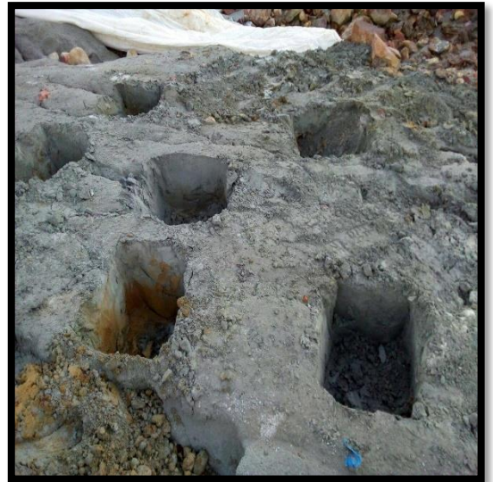
Imagen 02: Muestreo de suelo por calicatas de 10x10x30
