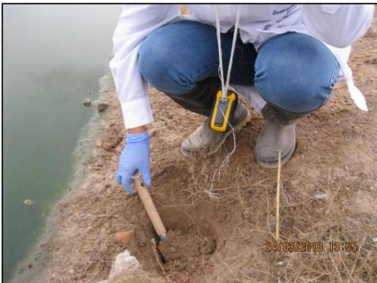
En la foto se observa el momento en que se está extrayendo la muestra con una pala de acero, para su posterior análisis en el laboratorio.
