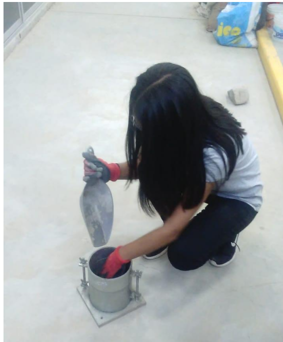
Figura N°17: Vaciado del material en cada capa para compactar
