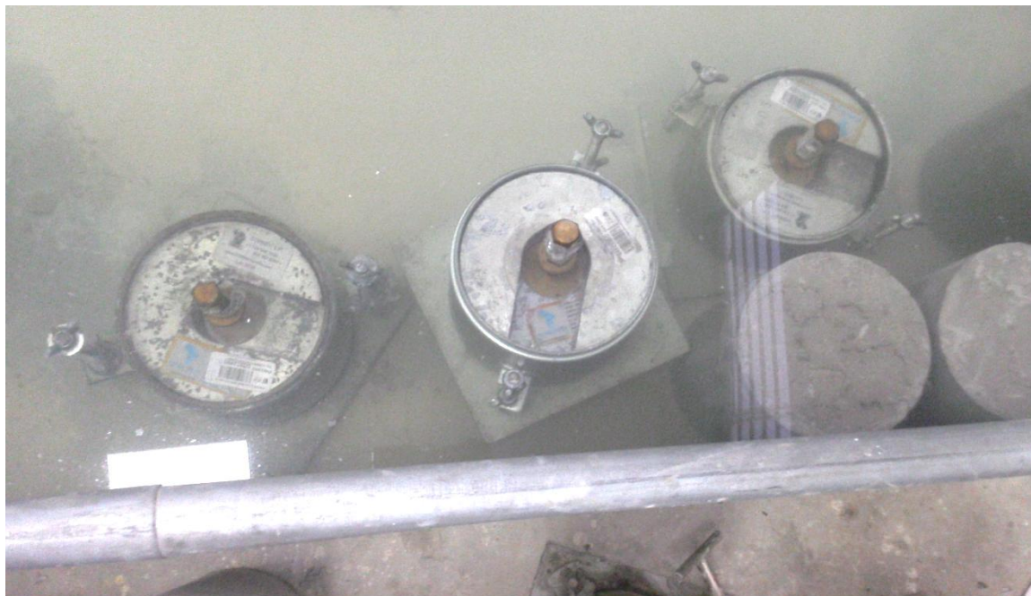
Figura N°25: Muestras sumergidas en el agua con y sin CaCl 2 durante 96 horas.
