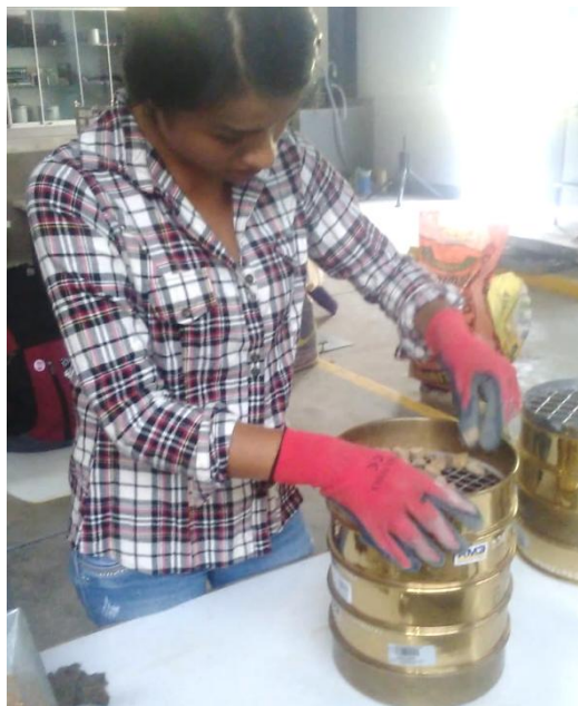
Figura N°07: Tamizado de las muestras en estudio
