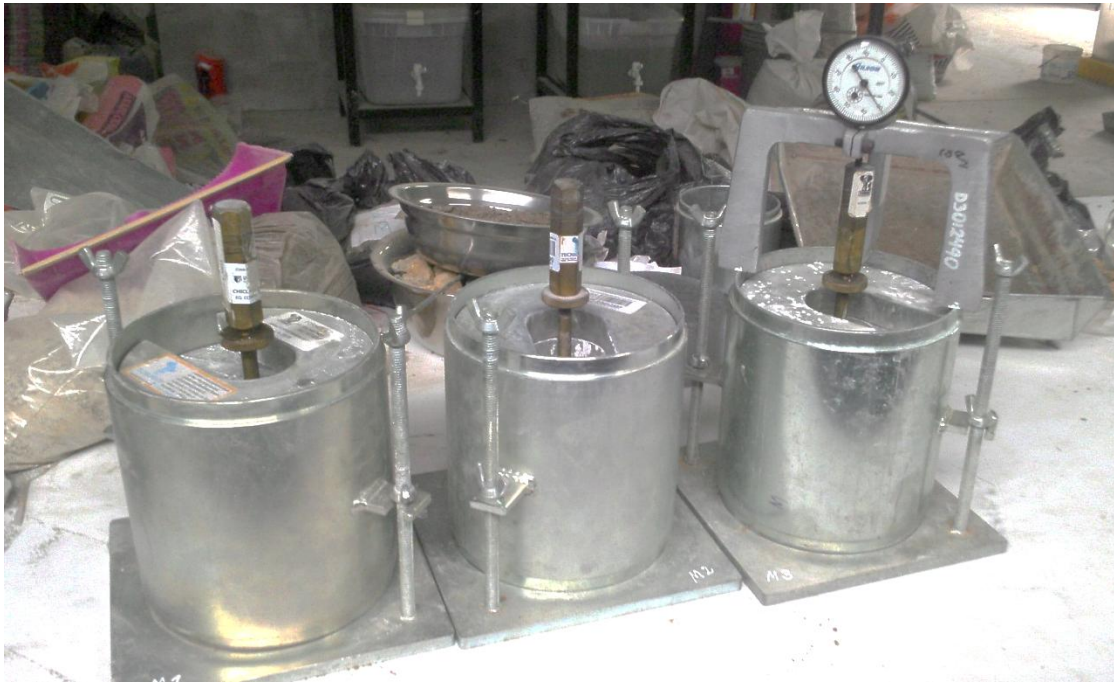
Figura N°24: Muestras listas para calibrar y medir su expansión durante 4 días.
