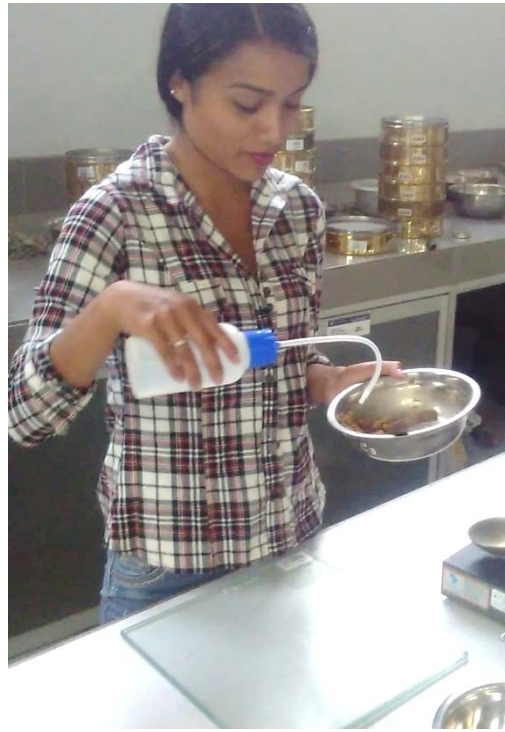
Figura N°12: Elaboración del Límite Plástico
