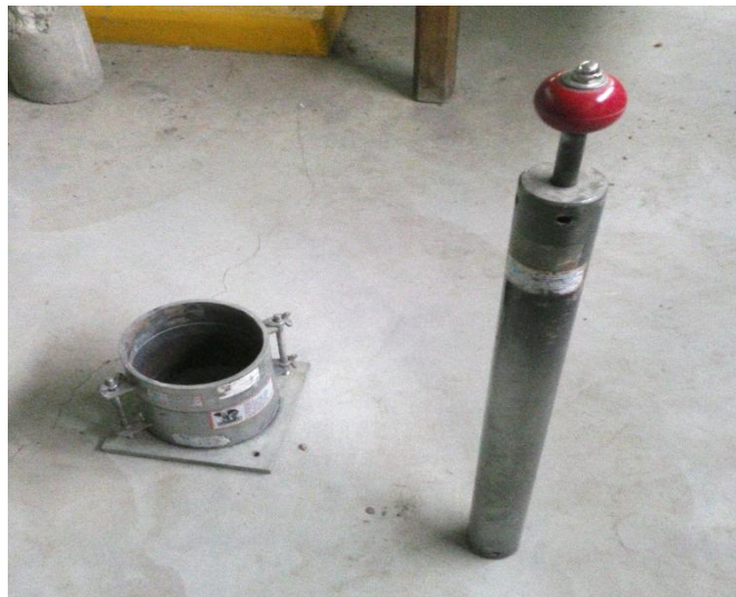
Figura N°15: Equipo listo para el proctor modificado
