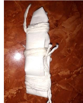
Muestra mezclada con arena fina y colocada en cartucho de papel de filtro
