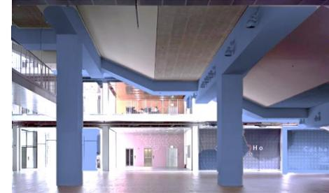
El sistema estructural se compone de el uso del pórtico de concreto, ya que la extensión y complejidad espacial que exige el proyecto merece este tipo de sistema por sus altísimas cargas, su carácter de edificio esencial y su aporte volumétrico espacial. Uno de los factores a destacar es la existencia de múltiples alturas en el conjunto que exigen la estructuración individual de algunas zonas.
